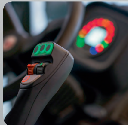
Pilotage réactif et précis de la machine et des équipements à moyen d'un joystick à commande pilote hydraulique.
