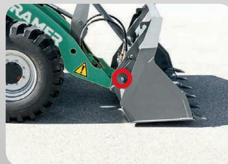
Le système d'attache rapide Kramer : approcher simplement la machine de l'équipement. Réceptionner l'équipement depuis le siège et sans perdre le contact visuel. Verrouiller au moyen d'un bouton-poussoir situé sur le joystick.
