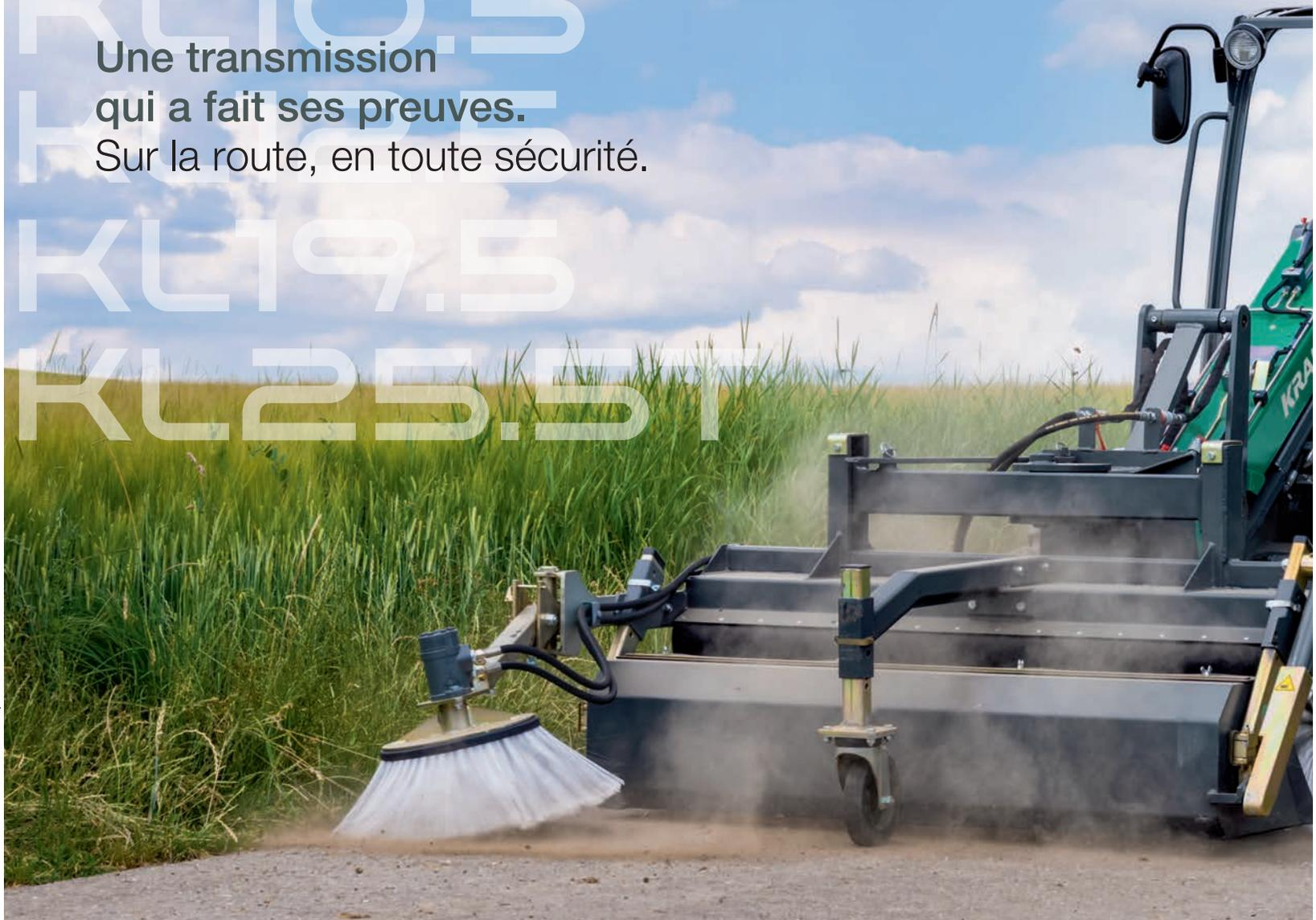
Tous les modèles de la classe compacte Kramer sont équipés d'une motorisation efficace adaptée aux besoins, ainsi que d'une transmission sans palier grâce à la technique hydrostatique ultra moderne.
