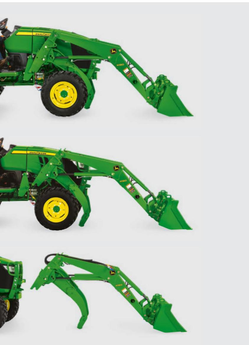
**Système « Quik-Park » de montage du chargeur :** les chargeurs séries H et R sont conçus pour une installation et une dépose faciles et sans outils. Leurs béquilles intégrées se fixent à l'avant du tracteur et font partie intégrante du chargeur lors de son utilisation. Pour décrocher le chargeur et le mettre en position parking, il suffit d'actionner le joystick après avoir libéré les verrous.
