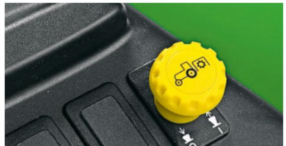
**Prise de force indépendante :** Plus besoin d'immobiliser votre tracteur et d'engager manuellement la prise de force. Avec la prise de force à commande électro-hydraulique, vous pouvez activer l'outil en marche, ce qui facilite et accélère le travail.
