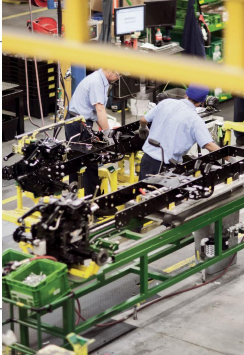
Deux ouvriers de l'usine d'Augusta montent une transmission sur le robuste châssis en acier d'un tracteur compact.
