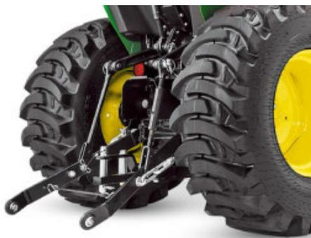
**Attelage arrière 3 points de catégorie 1 :** Cet attelage affiche la capacité de levage nécessaire à l'utilisation d'une multitude d'équipements.
