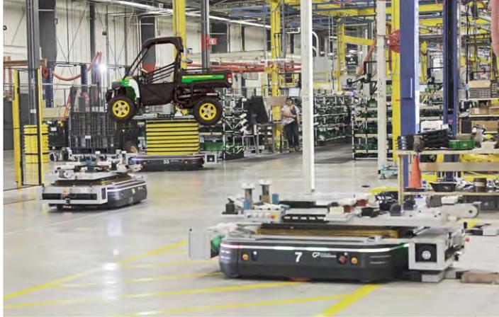
Un robot mobile appelé OTTO se recharge à une station d'accueil. OTTO transporte continuellement les éléments le long de la chaîne de montage pour maintenir une production sans faille.
