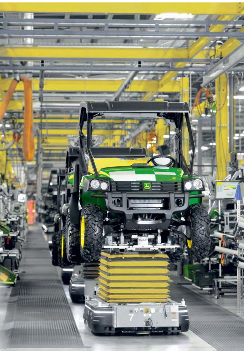
Gator produits à la demande en attente d'expédition. Pour une polyvalence maximale, toutes les configurations peuvent désormais être assemblées sur deux chaînes de montage dans la nouvelle usine.
