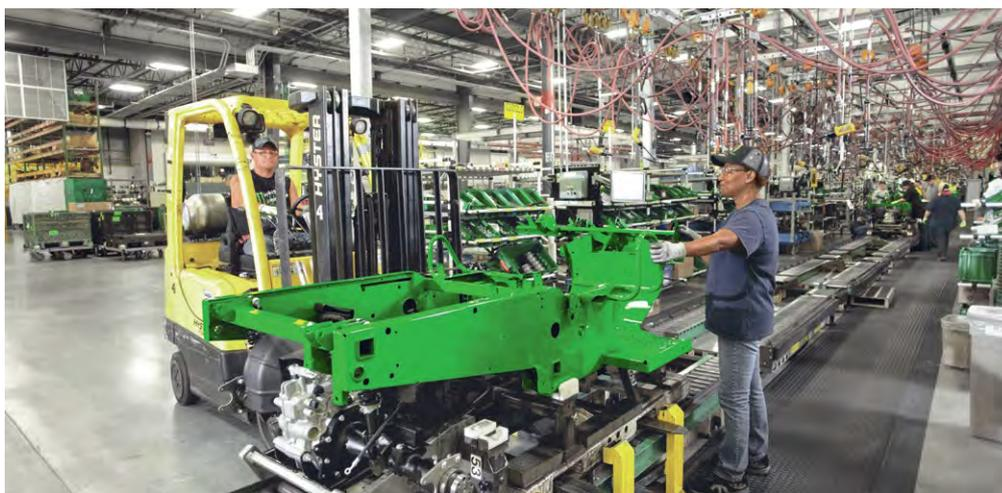
Un châssis et une transmission traditionnels de la série T sont placés sur la chaîne de montage. Au bout de la chaîne, nous aurons un Gator série T entièrement monté.
