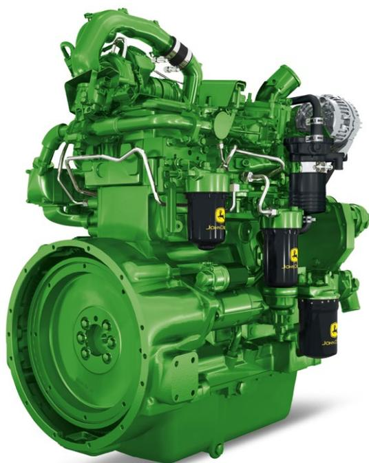
Nos moteurs 4,5 l PSS (6110R, 6120R, 6130R et 6135R) ont recours à un système de turbocompression à double étage dans lequel un turbocompresseur à Wastegate multiplie la pression générée par un turbocompresseur à ailettes fixes. Cette disposition séquentielle décuple la puissance pour atteindre jusqu'à 166 ch (max avec IPM) pour le 6135R.
