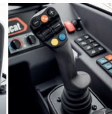
Manipulateur Smart avec fonction de position flottante de la flèche et secouage du godet
