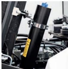
Suspension de flèche (accumulateur d'azote)
