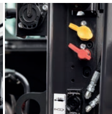
Prise ABS, sorties auxiliaires hydrauliques arrière à double effet et frein de remorque hydraulique
