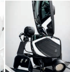
Feux de travail à LED supplémentaires et rétroviseur électrique avec dégivrage
