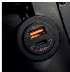
Prises USB A et C pour le chargement d'appareils mobiles
