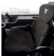
Siège à suspension pneumatique, avec appuie-tête
