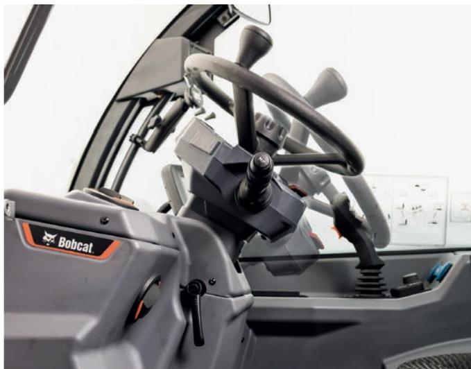
Colonne de direction télescopique et inclinable
