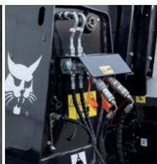
Conduite hydraulique auxiliaire avec système FCS\*
