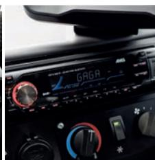
Radio Bluetooth avec fonction DAB et microphone
