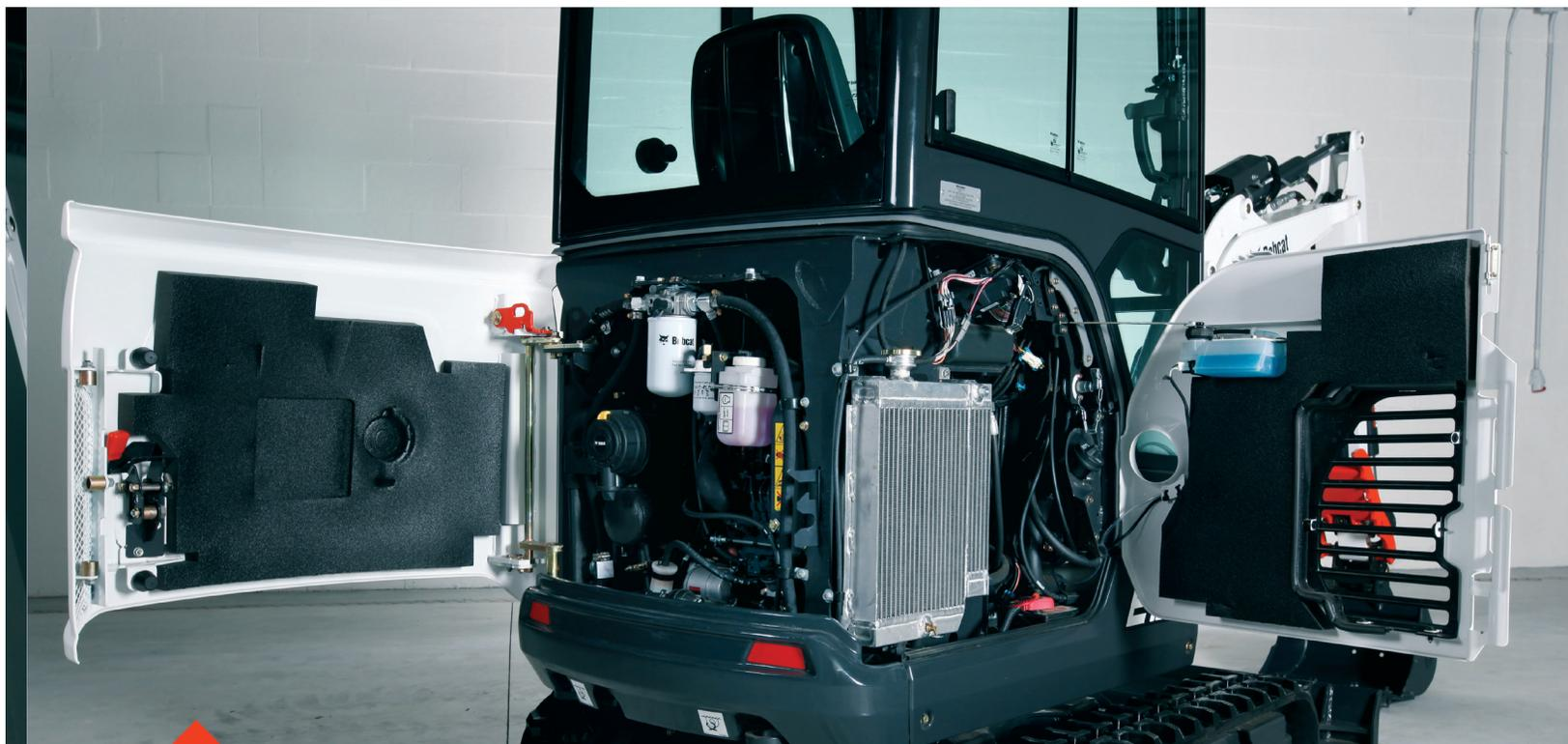
Les refroidisseurs sont montés côte à côte pour faciliter leur nettoyage. Grâce aux codes d'erreur affichés sur le panneau de contrôle et à la prise destinée à connecter l'outil de service, les diagnostics s'effectuent rapidement. Avec tous leurs capots ouvrants ou amovibles, les E17, E17z, E19 et E20z offrent le meilleur accès aux points de contrôle et d'entretien quotidiens de toutes les machines de leur catégorie.
