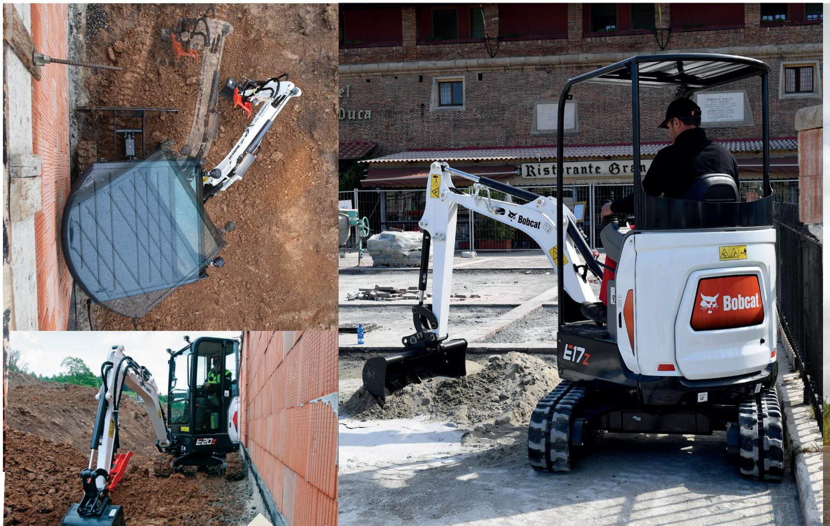
La tourelle à orientation sans déport (ZHS) offre encore plus de liberté de manœuvre que la tourelle sans déport arrière (ZTS) : même les coins avant de la tourelle restent dans le gabarit des chenilles pendant l'orientation. Avec la tourelle ZHS, l'opérateur dispose de 320° de rotation libre lorsque la machine est positionnée près d'un obstacle.
