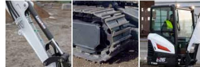
Balancier long Chenilles en acier Cabine TOPS / ROPS / FOPS avec chauffage
