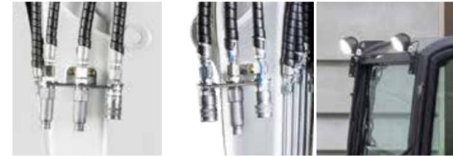
Circuit hydraulique auxiliaire (AUX1) sur le balancier 2e circuit hydraulique AUX + conduite de vidange Témoins supplémentaires (2+1)
