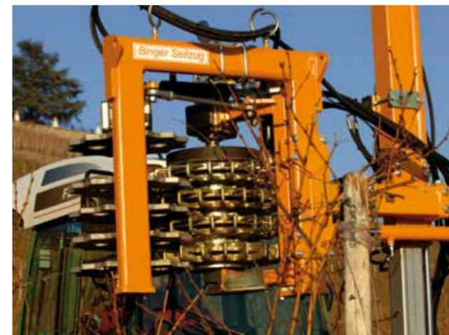
Le régime des disques ameneurs et des cages est soumis à un réglage indépendant qui permet de l'adapter à la vitesse d'avancement du véhicule.
