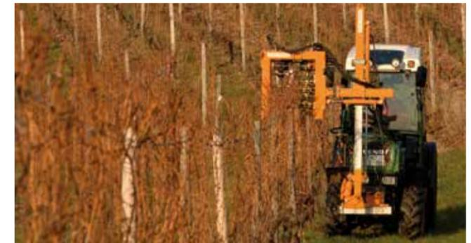
La VS 98 S est disponible avec plusieurs hauteurs de coupe, de 18 cm à 81 cm, et avec un écartement de 9 cm ou 12 cm entre les scies. Un châssis plus long ménageant un espace libre de 20 cm au-dessus de la scie supérieure est disponible en option.
