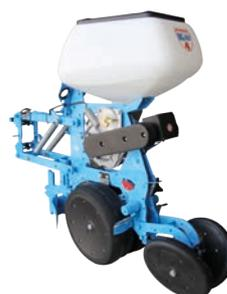
Les éléments semeurs NG Plus 4 peuvent disposer de l'entraînement électrique des distributions. Chaque distribution est entraînée par un moteur électrique via une courroie crantée. Placé sur le semoir, le module ECU permet à l'utilisateur de gérer sa densité de semis en cabine depuis le terminal ISOBUS TOUCH ou TOUCH Mini. Ce système d'entraînement offre également l'avantage d'être compatible avec la gestion des coupures de rangs automatique par GPS (fonction TC-SC).
