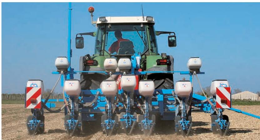
La version Extend mixte 6/7 rangs offre des écartements de 75 et 80 cm en 6 rangs et de 55 et 60 cm en 7 rangs. Il est ainsi possible de passer très rapidement et sans démontage d'un 6 rangs Maïs à un 7 rangs Tournesol/Colza.
