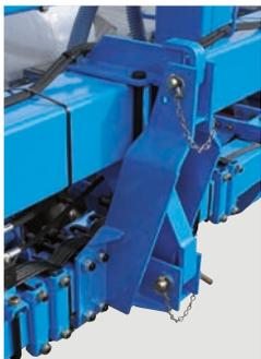
Le principe de fixation des semoirs sur la barre d'accouplement permet à chaque ensemble de suivre les dénivellations du terrain.
