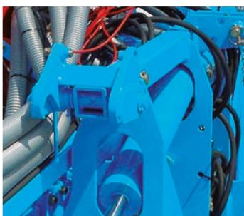
Les extrémités sont automatiquement verrouillées en position transport. Le déverrouillage s'effectue depuis la cabine du tracteur.
