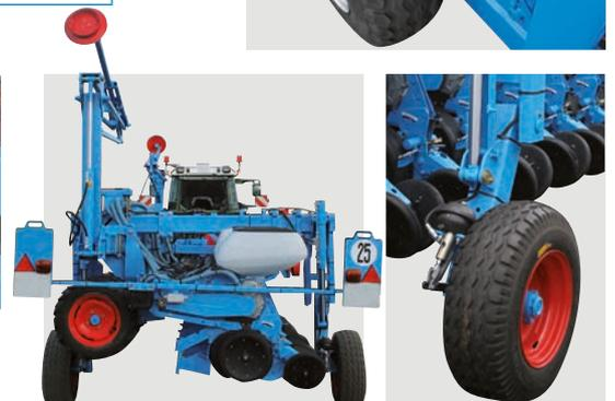
Pour faciliter le transport, un chariot de transport en long est disponible en option. Ce chariot de transport est équipé en option d'un système de freinage hydraulique ou pneumatique.
