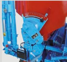
Facilement accessible sur le côté du semoir, la transmission par variateur FertiDrive<sup>VM</sup> permet un réglage très facile et rapide de la quantité d'engrais à l'hectare souhaitée. Cette transmission est également équipée d'un débrayage qui permet d'arrêter l'apport d'engrais là où ce n'est pas nécessaire.
