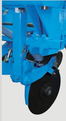
Sur le semoir Extend, une turbine Double fonction (Df) assure une aspiration efficace des graines et permet d'autre part de pulser l'engrais des rangs extérieurs pour un apport aussi efficace à 45 qu'à 80 cm d'inter-rangs. Sur les rangs pulsés, un cyclone inox est intégré dans chaque enfouisseur à disques.
