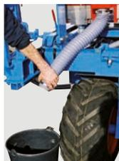
Les trémies fertilisateur « Grande capacité » sont équipées de chaque côté d'une trappe avec un tuyau permettant une vidange simple et rapide des trémies.
