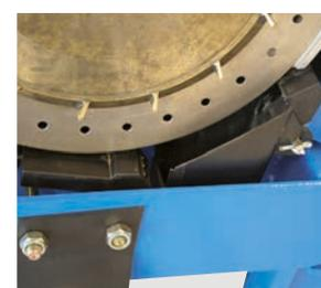
Les cellules des contrôleurs de semis sont placées sous les boîtiers des distributions. Un faisceau lumineux permet de contrôler le passage des graines, même les plus petites.
