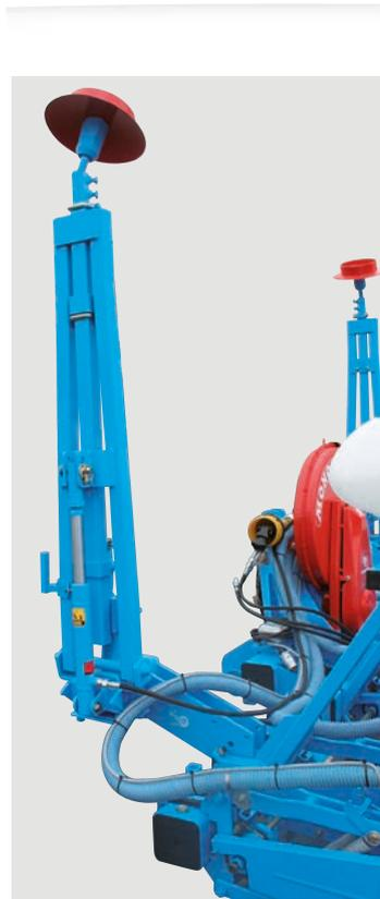
Les rayonneurs sont fixés sur la poutre principale du châssis pour limiter les contraintes sur les extensions télescopiques (Monobloc 125).
