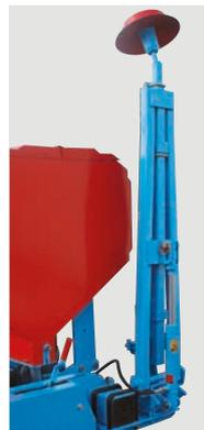
Des rayonneurs hydrauliques sont montés de série sur tous les semoirs.
