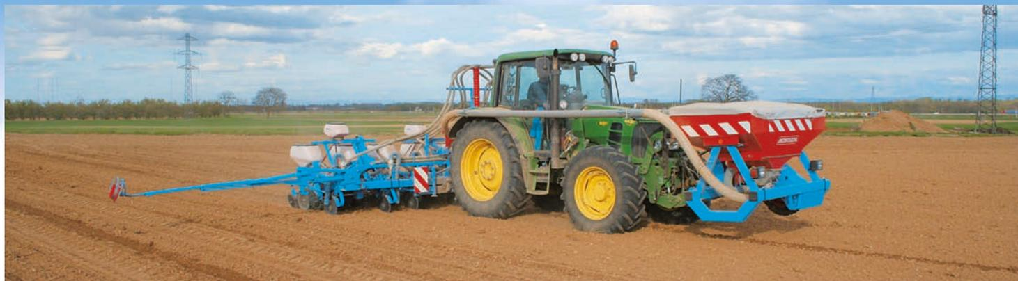
Les trémies frontales MONOSEM ont été spécialement développées pour la fertilisation. Le robuste châssis avec berceau de dépose intégré et le boîtier de distribution 100% inox témoignent du soin apporté à sa fabrication. La turbine peut être entraînée par prise de force ou moteur hydraulique.
