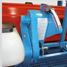
Le Microsem dispose d'un entraînement par variateur MicroDrive<sup>VM</sup> facilement accessible sur le côté du semoir pour un réglage rapide et précis de la dose apportée. Cette transmission est également équipée d'un débrayage qui permet d'arrêter le microgranulateur là où ce n'est pas nécessaire.
