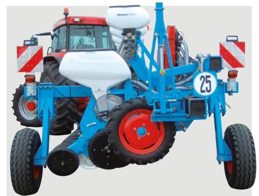
Un chariot de transport (transport en long) est disponible pour les semoirs de grande largeur. Ce chariot de transport peut être à relevage manuel ou hydraulique.
