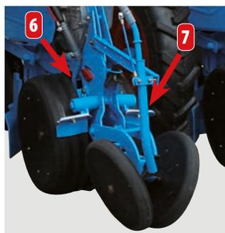
La descente du Microsem insecticide (6) est placée entre les 2 disques pour un apport dans la ligne de semis.
