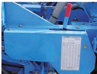
L'entraînement des éléments est assuré par une transmission renforcée. La boîte de distances est située sur le côté du semoir pour un accès facile et un changement rapide des pignons. Les 20 vitesses avec pignons interchangeables offrent une large plage de réglages de la densité de semis.
