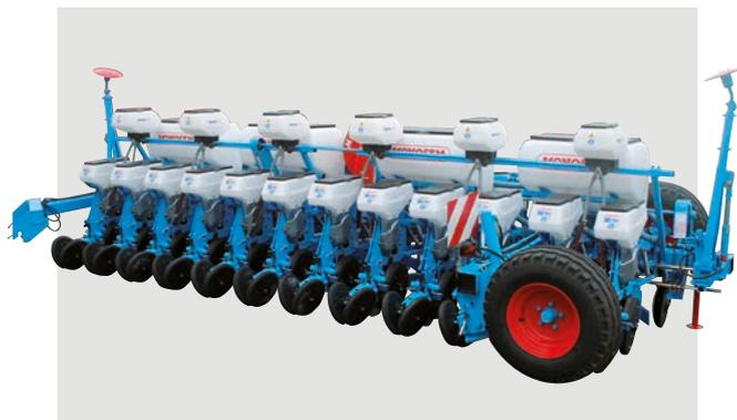
Semoir 12 rangs rigide Double-barre (45 cm d'inter-rangs) avec chariot de transport en long
