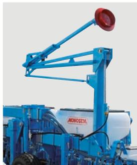
Les rayonneurs triples offrent un repliage compact pour un encombrement minimal au transport.
