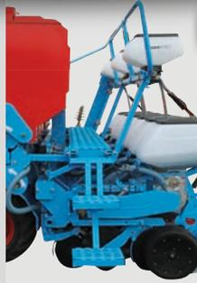
Sur les semoirs Extend avec fertiliseur, une passerelle, livrée de série, permet un accès facile à la trémie du fertiliseur. La passerelle et le marchepied permettent ainsi un accès sécurisé à la trémie lors des opérations de remplissage.
