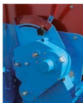
Les fertilisateurs des châssis Monobloc2 Confort, Extend et TFC sont équipés d'un entraînement par variateur pour un réglage simple et précis de la quantité d'engrais à apporter.
