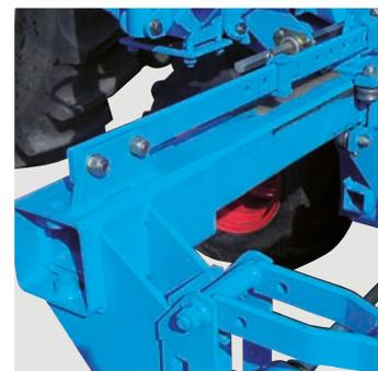
Les poutres télescopiques hydrauliques assurent le déplacement latéral des éléments de semis pour changer d'inter-rangs. Pour limiter les frottements et assurer une longévité supérieure, les poutres sont équipées de galets de guidage montés sur bagues.
