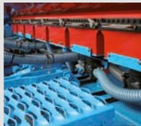
Les semoirs TFC sont équipés d'un fertiliseur de 1500 L. Les fertiliseurs sont équipés de 8 distributeurs avec trappes de fermeture individuelles inox. Une turbine Double fonction (Df) assure une aspiration efficace des graines et permet d'autre part de pulser l'engrais sur les 4 rangs extérieurs. Un marchepied permet un accès sécurisé à la trémie.
