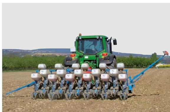
Semoir 11 rangs rigide Monobloc (37,5 cm d'inter-rangs ou 6 rangs à 75 cm d'inter-rangs)
