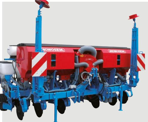
Les trémies « Grande capacité » en tôle des châssis Monobloc, simple ou double télescopique ont une capacité de 980 L.
