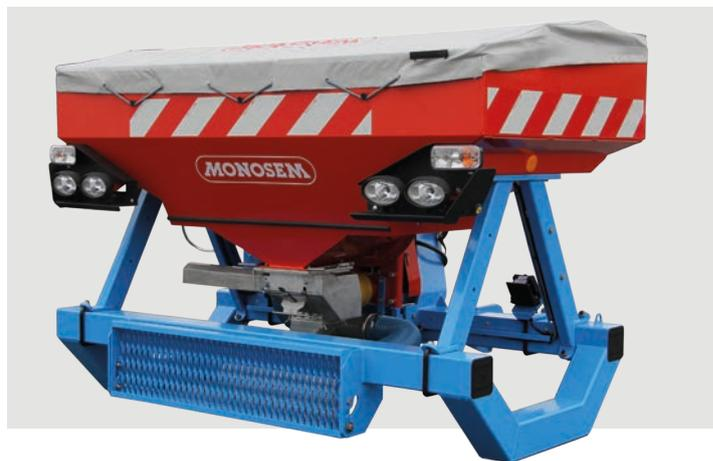
La trémie frontale standard est disponible en capacité de 1000L ou 1600L. L'ensemble peut se monter sur les semoirs jusqu'à 12 rangs. Ce fertiliseur dispose d'une distribution Inox et d'un entraînement mécanique ou électrique, pour un réglage rapide de la quantité d'engrais à apporter.
