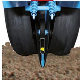
La pointe finit le fond du sillon pour un placement optimal des graines.
