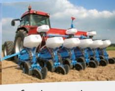
Semoir pneumatique polyvalent NG Plus 4 à disques
