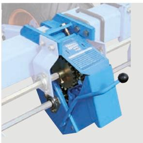
La boîte de distances standard à 18 rapports permet un réglage rapide et précis de la population. La boîte de distances standard à 18 rapports permet un réglage rapide et précis de la population. Un simple levier permet de détendre la chaîne. Il suffit ensuite de placer les pignons souhaités l'un en face de l'autre puis de lâcher le levier pour retendre la chaîne.
