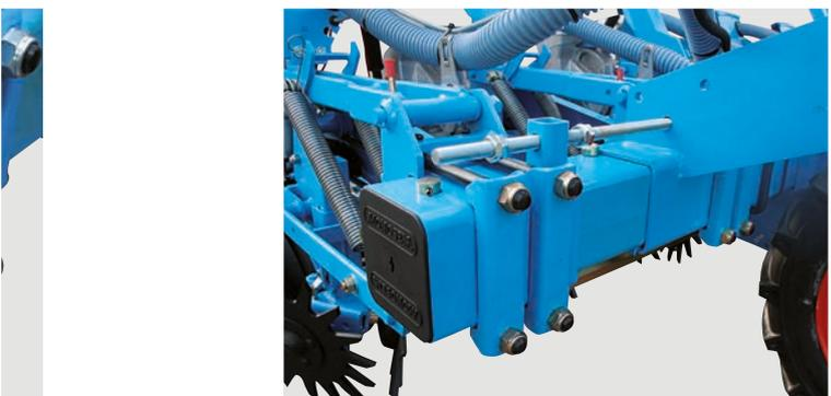
Des butées sur le système de télescopage permettent un réglage parfaitement adapté à l'inter-rang souhaité et un repliage adapté aux équipements.
