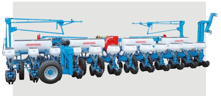
Semoir 12 rangs couplé (75 cm d'inter-rangs)
