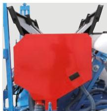
Les trémies fertilisateur « Grande capacité » offrent une ouverture large pour un remplissage « propre » et aisé du fertilisateur.
