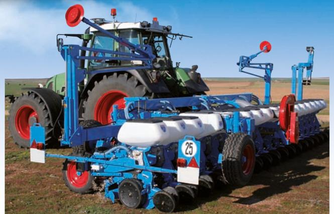
Semoir 18 rangs couplé (45 cm d'inter-rangs)
