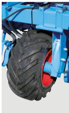
Les roues larges et de grand diamètre assurent un entraînement régulier et précis des distributions. Le réglage rapide en largeur des roues d'entraînement permet de s'adapter rapidement aux différentes voies des tracteurs.
