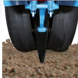
Les double-disques ouvrent le sillon d'une profondeur définie par les roues de jauge.
