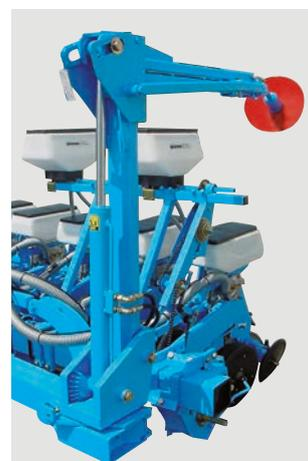
Les rayonneurs pivotants permettent un repliage compact pour un encombrement minimal au transport.
