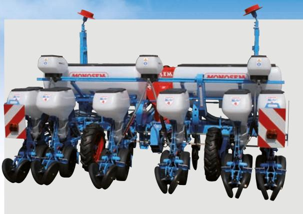
Semoir 6 rangs Monobloc simple télescopique (75 cm d'inter-rangs)
