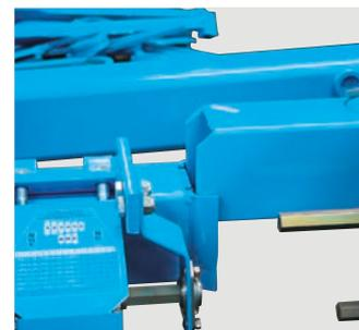
La jonction entre la partie centrale et les extrémités dispose d'un guide pour concilier robustesse et indépendance.
