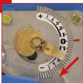
Pour les petites graines, l'aspiration est réduite simultanément au réglage du sélecteur.
