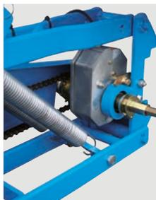
Embrayage électromagnétique sur élément NG Plus 4.
