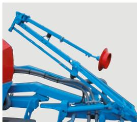
Les rayonneurs des châssis repliables TFC permettent un repliage compact pour un encombrement minimal au transport.
