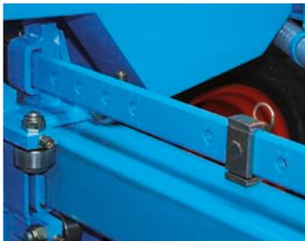
Le réglage de l'inter-rang du semoir NG Plus 4 Extend est très simple. Il suffit tout d'abord de positionner les butées sur les barres de réglages aux écartements souhaités, puis d'allonger ou de raccourcir les vérins hydrauliques des poutres télescopiques pour obtenir l'écartement désiré.
