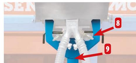
La capacité des trémies des Microsem est de 20 litres. Des trémies de 40 litres sont aussi disponibles en option (Montage selon châssis). Les trappes (8) et la goulotte (9) permettent une vidange simple et rapide des produits restants.
