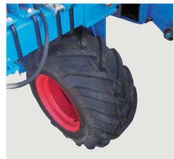
Les roues larges et de grand diamètre assurent un entraînement régulier et précis des distributions. Le réglage rapide en largeur des roues d'entraînement permet de s'adapter rapidement aux différentes voies des tracteurs.
