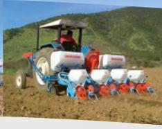
Semoir pneumatique polyvalent NC à socs
