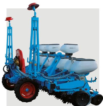
Le châssis Monobloc déport long avec bloc roue avant autorise des inter-rangs réduits de 37,5 cm.
