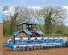
Semoir mécanique à betterave enrobée MECA V4
