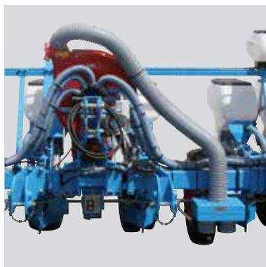
Selon la réglementation en vigueur, MONOSEM peut proposer sur ses semoirs des kits antidérives de poussières (KAP). Ces kits sont homologués par le BBA Allemagne et garantissent le bon fonctionnement des semoirs MONOSEM.
