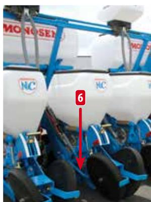
La descente du Microsem insecticide (6) est placée derrière le soc pour un apport dans la ligne de semis. Une descente hélicide est également disponible pour un apport après le passage des roues tasseuses.
