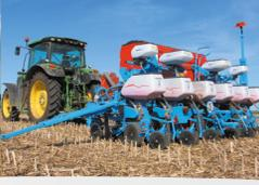
Semoir pneumatique spécial "semis simplifiés" Monoshox NX M à disques
