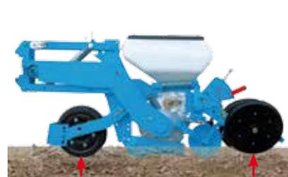
En « Balancier », le contrôle de la profondeur est assuré par la roue avant et le bloc tasseur arrière. Un ressort de réglage permet la répartition de charge avant/arrière jusqu'à un contrôle de profondeur « Jauge avant ».
