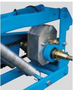
Embrayage électromagnétique sur élément NC
