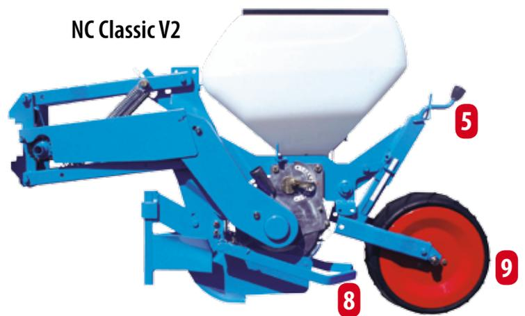
Sur les éléments semeurs NC Classic, le contrôle de la profondeur de semis s'effectue par l'intermédiaire des roues arrière.
