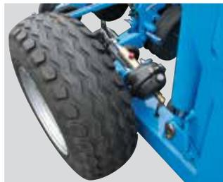
Des chariots de transport en long sont disponibles pour les châssis rigides et couplés. Pour les châssis rigides, le chariot dispose d'un relevage hydraulique ou manuel. Pour les châssis couplés, le relevage est hydraulique et est équipé, en option, d'un système de freinage hydraulique ou pneumatique.
