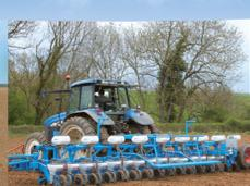
Semoir mécanique à betterave enrobée MECA V4
