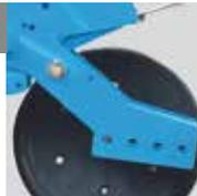
Ces roues inclinées disposent d'un écartement réglable, de quatre positions longitudinales et de décroisseurs\*.
