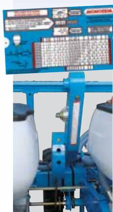
Le réglage des microgranulateurs s'effectue grâce à une boîte de vitesses à 18 rapports. Si besoin, d'autres pignons sont disponibles ainsi qu'un système de débrayage rapide.
