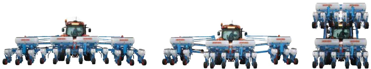
La partie centrale du châssis est composé d'un châssis double télescopique, les extrémités sont quant à elles télescopiques et repliables pour une largeur de transport de 3 m (suivant équipement).
