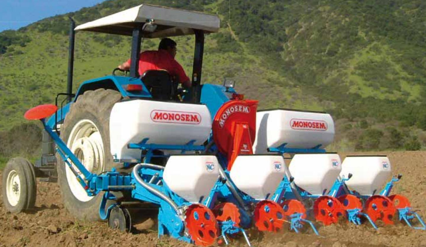
*Semoir pneumatique à enterrage à soc*
