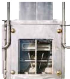
La distribution 100 % inox du fertiliseur avant dispose d'une trappe de fermeture et se démonte rapidement.
