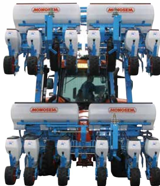
\* Exemple du châssis CRT replié à 3 m 00
