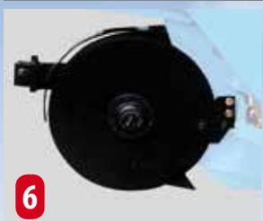
**6** Un double-disque est adaptable sur l'élément NC afin d'améliorer l'ouverture du sillon (semis avec préparations plus superficielles ou en présence de débris végétaux).
