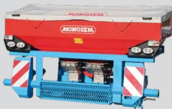
La trémie frontale DUO est disponible en capacités de 1500L ou 2100L. L'ensemble peut se monter sur les semoirs jusqu'à 16 rangs. Ce fertiliseur dispose d'une double distribution Inox et d'un entraînement électrique pour un réglage rapide de la quantité d'engrais à apporter.
