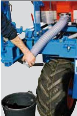
Les trémies fertiliseur « Grande capacité » sont équipées de chaque côté d'une trappe avec un tuyau permettant une vidange simple et rapide des trémies.
