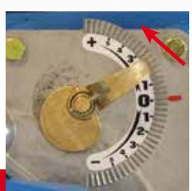
Pour les grosses graines, l'aspiration est maximale et le sélecteur est réglé en fonction de la taille de la graine.
