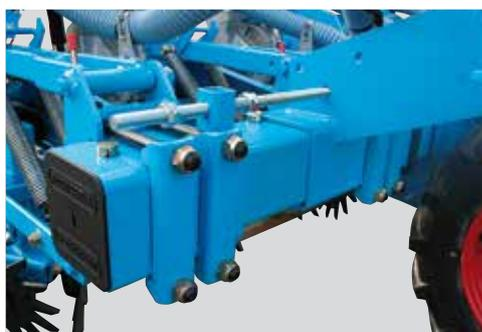
Des butées sur le système de télescopage permettent un réglage parfaitement adapté à l'inter-rang souhaité et un repliage adapté aux équipements.
