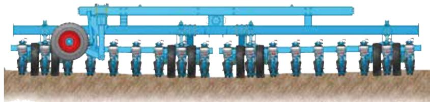
Sur les châssis de grande largeur, un bon suivi du terrain est primordial. C'est pourquoi, chaque châssis composant un châssis couplé est indépendant et dispose d'articulations permettant un parfait suivi du terrain.
