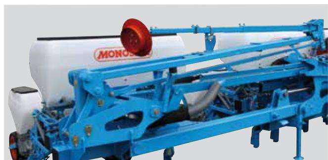
Les rayonneurs des châssis repliables Double-barre et CRT permettent un repliage compact pour un encombrement minimal au transport.
