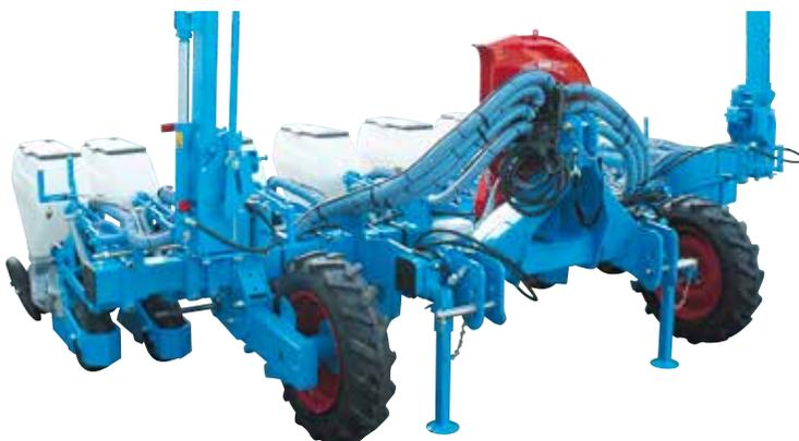
Semoir avec blocs roues avant pour semis à inter-rangs réduits (jusqu'à 37,5 cm) ou en conditions pierreuses
