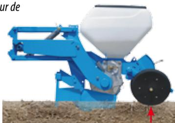
En « Jauge arrière », le contrôle de la profondeur est assuré par le bloc tasseur arrière.
