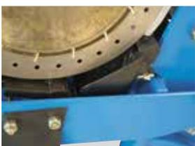
Les cellules des contrôleurs de semis sont placées sous les boîtiers des distributions. Un faisceau lumineux permet de contrôler le passage des graines, même les plus petites.
