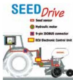
Le système de régulation hydraulique de la densité de semis Seed-Drive remplace la ou les boîtes de vitesses du semoir par un ou plusieurs moteurs hydrauliques qui entraînent les distributions. Ce système offre ainsi la possibilité de moduler la densité de semis en continu depuis la cabine du tracteur avec le terminal TOUCH Mini, TOUCH ou autre terminal ISOBUS compatible.
