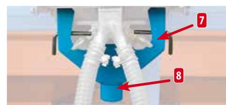
La capacité des trémies des Microsem est de 20L. Des trémies de 40 L sont aussi disponibles en option (Montage selon châssis). Les trappes (7) et la goulotte (8) permettent une vidange simple et rapide des produits restants.
