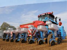
Semoir pneumatique polyvalent Monoshox NG Plus M à disques
