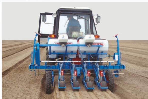
Semoir MS A - Rigide Monobloc - 4 rangs avec fertiliseur et Microsem
