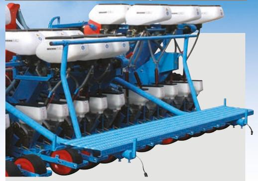
Une passerelle de contrôle de semis est disponible en option sur les semoirs MS. Cette passerelle, d'une largeur de 2m70 est équipée d'une main courante.
