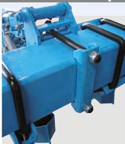
Le système de fixation des éléments par brides permet une fixation sûre et solide des éléments. En cas de besoin les éléments peuvent être déplacés pour modifier l'inter-rang en desserrant les brides. Ce principe de fixation exclut tout risque de déplacement latéral de l'élément au travail.
