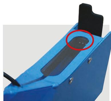
Les cellules des contrôleurs sont placées sous les boîtiers des distributions, à l'intérieur des socs. Un faisceau lumineux permet de contrôler le passage des graines, même les plus petites.
