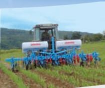
Semoir pneumatique polyvalent Monoshox NG Plus M à disques
