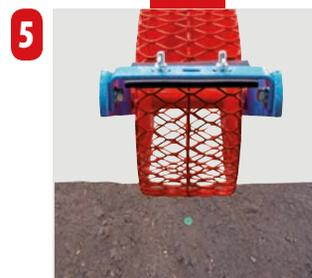
5) La roue arrière referme le sillon autour de la graine pour une germination optimale des graines.
