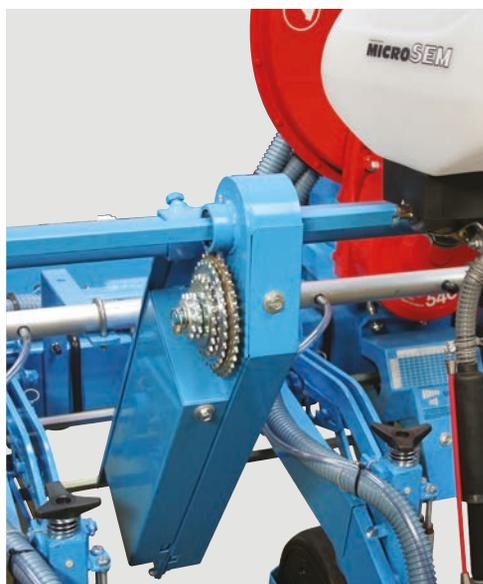
Le réglage des microgranulateurs s'effectue grâce à une boîte de vitesses 3 niveaux. Elle offre une large plage de réglages (40 rapports) pour répondre à la majorité des besoins.
