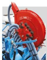
Les turbines MONOSEM sont silencieuses, fiables, performantes et assurent une dépression régulière pour un fonctionnement optimum des distributions. Nos turbines disposent, en standard, de 19 sorties et d'un entraînement par prise de force 540 tr/min. En option, des entraînements par pdf à 450 tr/min et 1000 tr/min sont disponibles ainsi qu'un entraînement par moteur hydraulique. Un cardan roue libre est aussi proposé en option.
