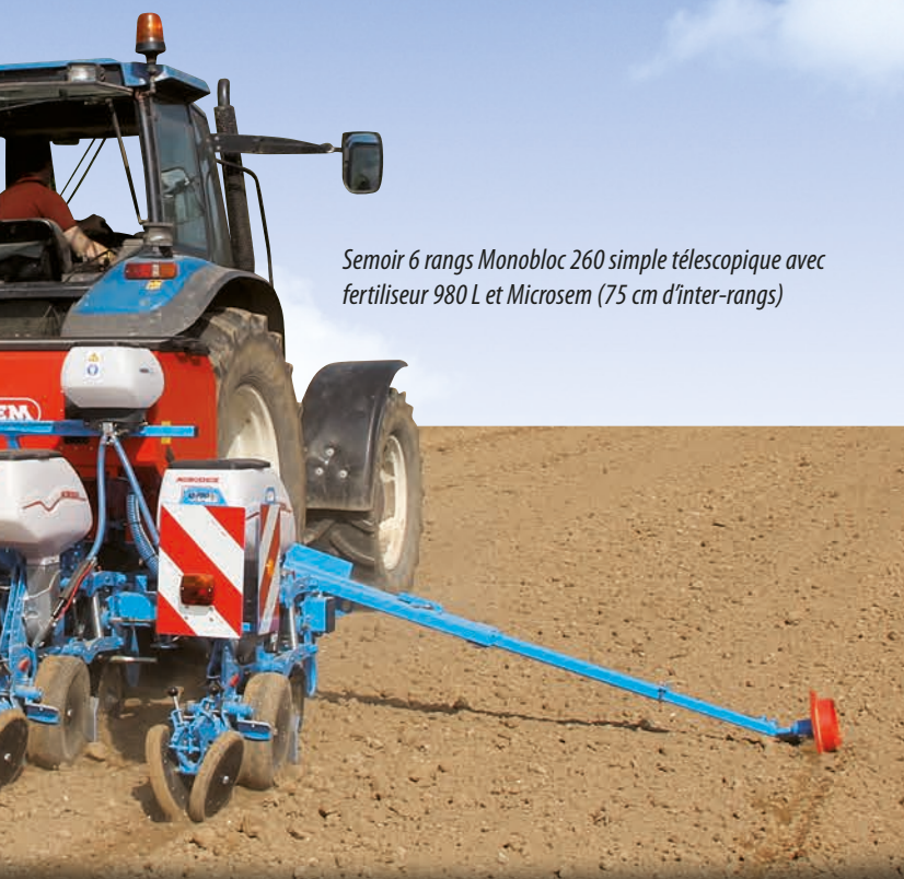
Semoir 6 rangs Monobloc 260 simple télescopique avec Microsem combiné (75 cm d'inter-rangs)
