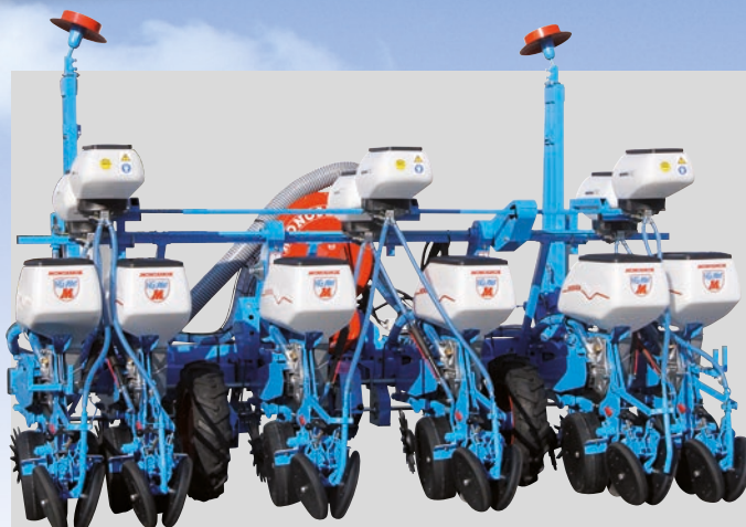
Semoir 6 rangs Monobloc 260 simple télescopique avec Microsem combiné (75 cm d'inter-rangs)
