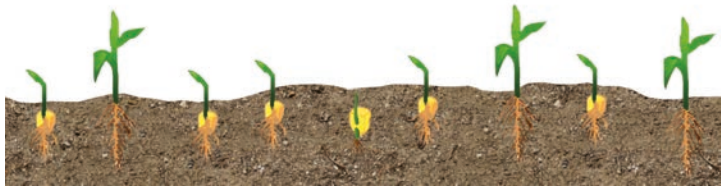
Semis à vitesse élevée sans Monoshox Espacement des graines et profondeur de semis irréguliers entraînant des levées hétérogènes
