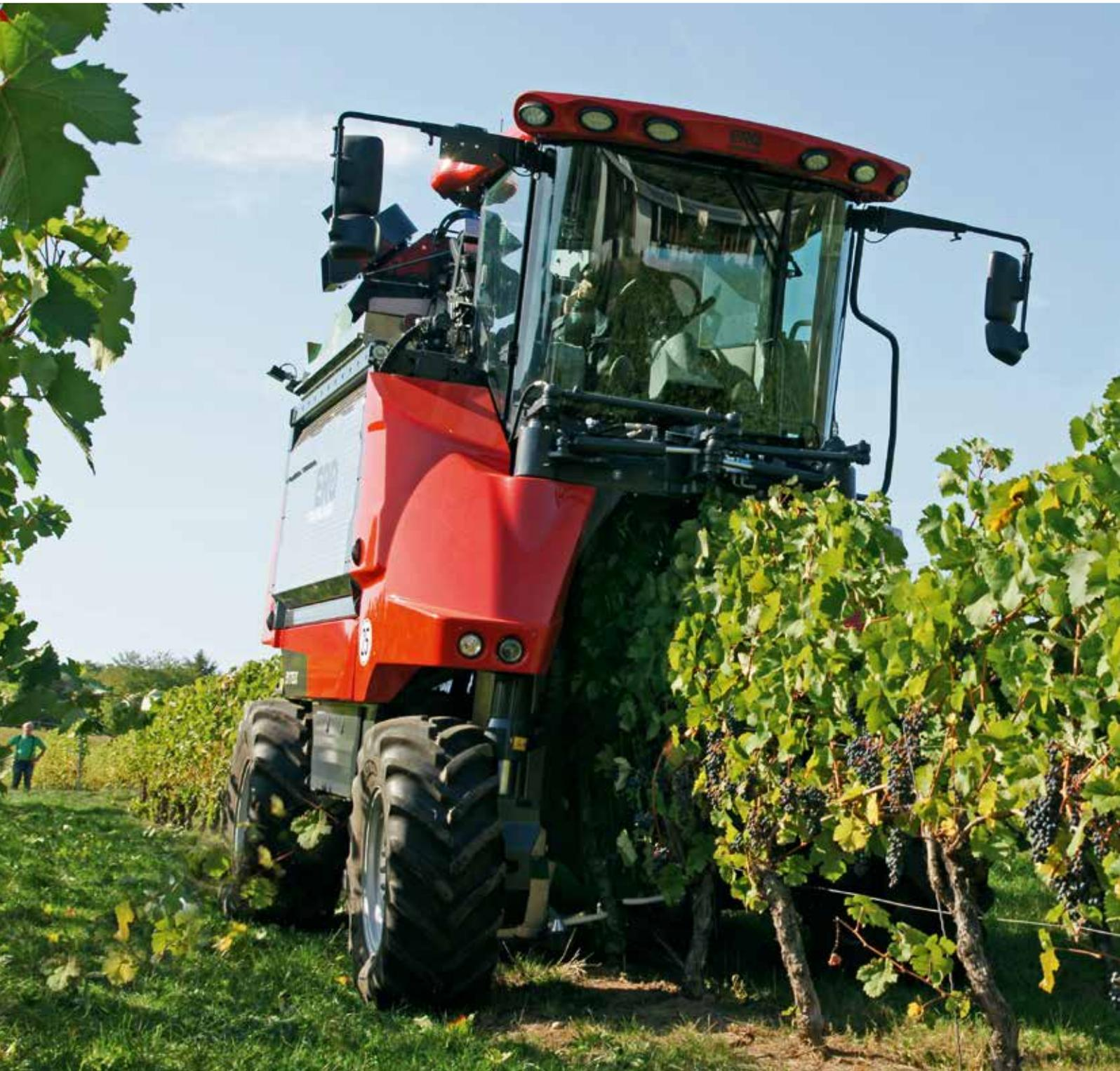
Les trois étapes du nettoyage de la vendange réduisent la proportion de végétation restante au minimum: jusqu'à 70 % des feuilles tombées sont séparées des baies sous l'action combinée d'un aspirateur à air transversal et d'un extracteur de feuilles avant de pouvoir se trouver en contact avec les raisins. La perte de jus est réduite à un minimum.
