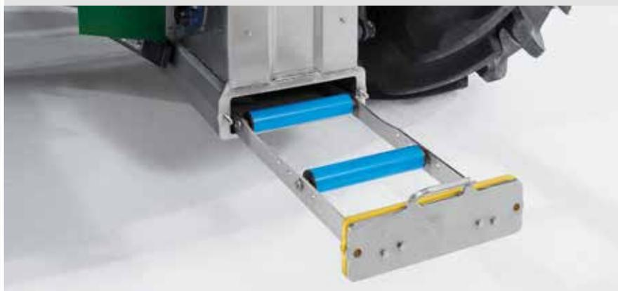
Le guidage du tapis de convoyage à l'aide de galets réduit le frottement et par conséquent l'usure. Dégagement facile pour le nettoyage.
