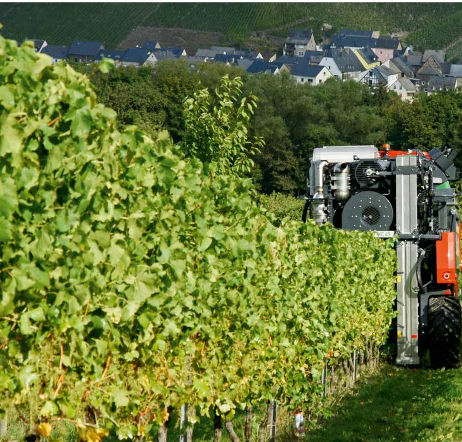
Nous avons équipée la ERO Grapelinier 5000 d'une tête de récolte à réglage de précision pour une récolte parfaite. Le nombre, l'espace et la souplesse des secoueurs ainsi que l'amplitude de secouage sont réglables séparément en fonction du cépage et du degré de maturité.
