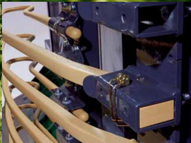
Système d'attache rapide des secoueurs (option)
