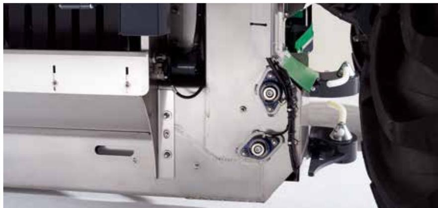
La rampe d'écailles fixée sur des silentblocs à faible entretien a été rallongée pour augmenter la surface de réception.
