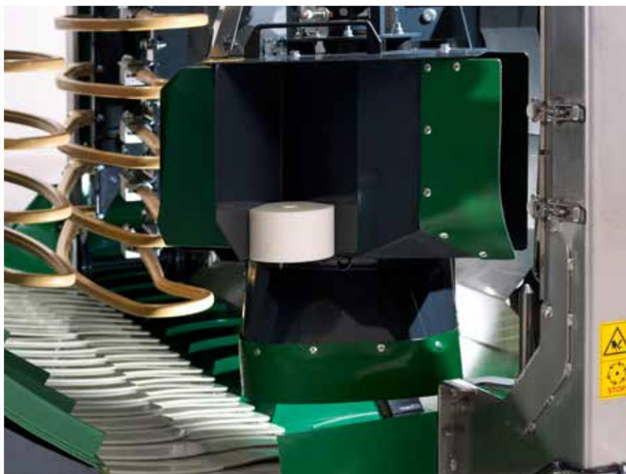
Commande électrique de la montée et de la descente de l'aspirateur inférieur pour un accès aisé et un nettoyage méticuleux.
