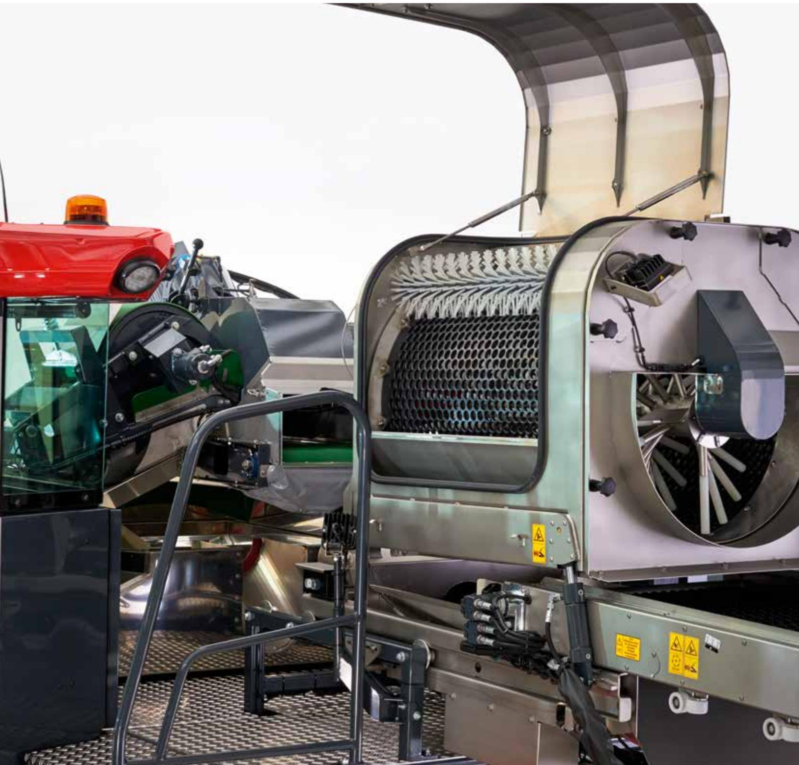
L'égrappoir de la Grapelin 5000 est doté d'une régulation de niveau automatique. Grâce à ce dispositif, les conditions restent constantes, même en terrain pentu. L'écran tactile permet de surveiller et de régler séparément le régime du panier et celui de l'arbre à broches pour une adaptation optimale au cépage et au degré de maturité. Les grandeurs sélectionnées peuvent être sauvegardées dans les programmes de récolte.
