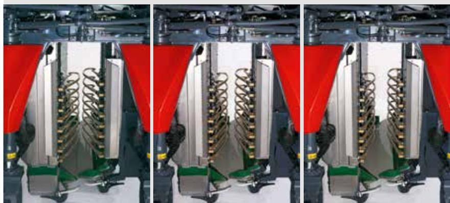
Réglage du pincement et système d'attache rapide des sécateurs supérieurs (en option) pour une adaptation à divers modes de conduite de la vigne sans aucun outil.
