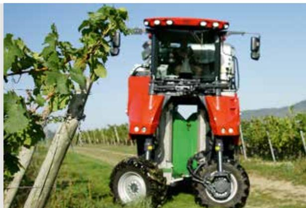
Les panneaux défecteurs d'un poids réduit sont faciles à décrocher et à accrocher pour l'entretien.
