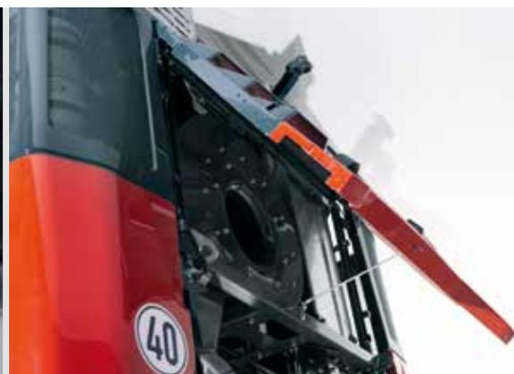
Les panneaux déflecteurs d'un poids réduit sont faciles à décrocher et à accrocher pour l'entretien.
