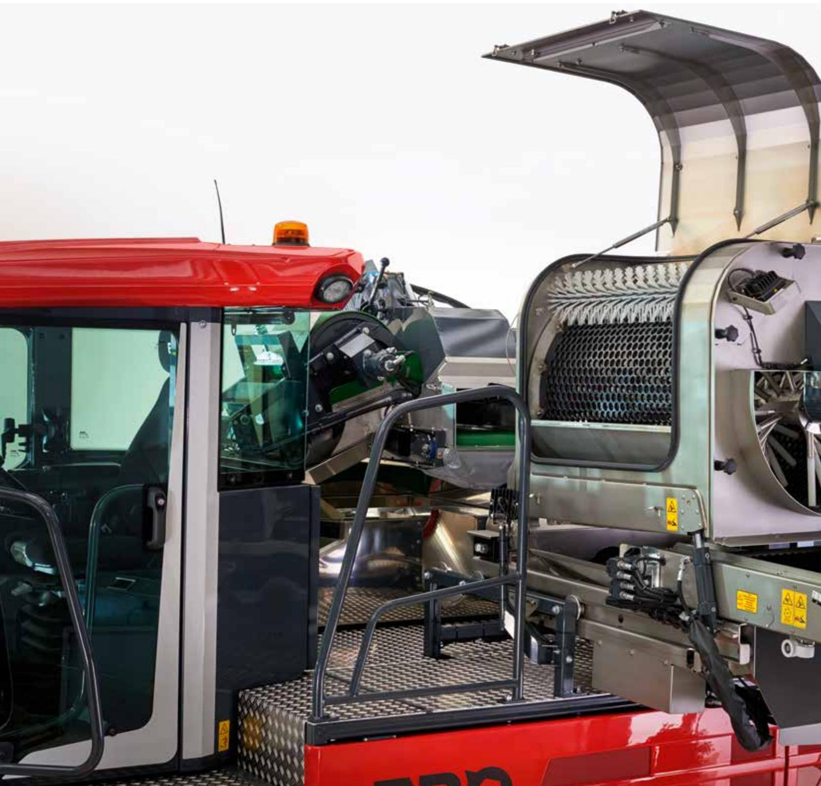
L'égrappoir de la Grapelinier 7000 est doté d'une régulation de niveau automatique. Grâce à ce dispositif, les conditions restent constantes, même en terrain pentu. L'écran tactile permet de surveiller et de régler séparément le régime du panier et celui de l'arbre à broches pour une adaptation optimale au cépage et au degré de maturité. Les grandeurs sélectionnées peuvent être sauvegardées dans les programmes de récolte.
