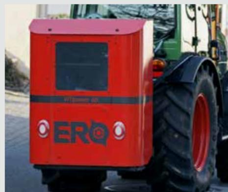
Centrale hydraulique avec pompe tandem
