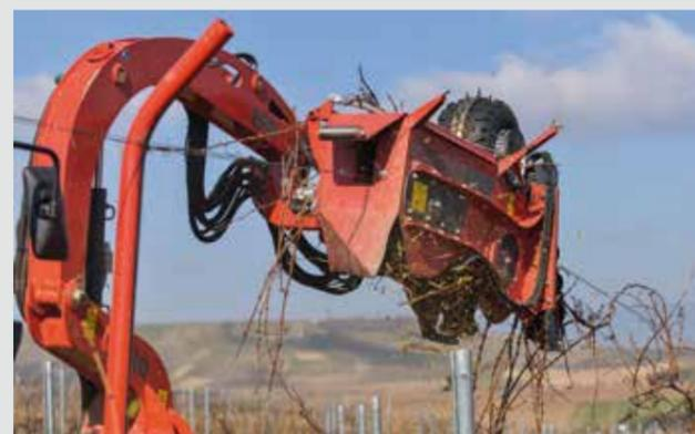
Tête de travail VITECO à réglage hydraulique sur 2 axes
