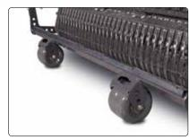
Une **adaptation au sol** optimale du pick-up est assurée par les deux roues danseuses et par la suspension optimisée du pick-up.
