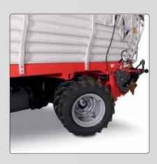
De série, la REFORM PrimAlpin peut être utilisée avec la **direction sur les 4 roues** du REFORM Muli. Les passages étroits tels que les entrées de ferme peuvent ainsi être franchis sans difficulté. Lors de la conception, l'accent a été mis sur une construction compacte, au plus près de l'axe.
