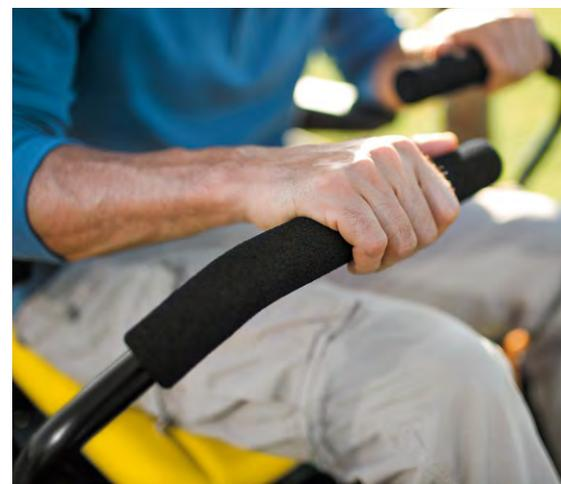
**Demi-tours sur place** : Les leviers de commande de déplacement peuvent être réglés à deux hauteurs et dix-huit positions longitudinales différentes, offrant un meilleur confort et une plus grande précision à l'utilisateur.
