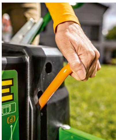
**Frein de stationnement** : Le frein de stationnement est situé à portée de main et maintient la tondeuse en position de stationnement de manière très sûre, même sur un terrain en pente.
