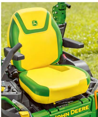
**ComfortGlide™** : Lors des démarrages et arrêts brusques en terrain accidenté, le siège amortit les chocs en glissant vers l'avant ou vers l'arrière sur une distance pouvant atteindre 5,1 cm (2").
