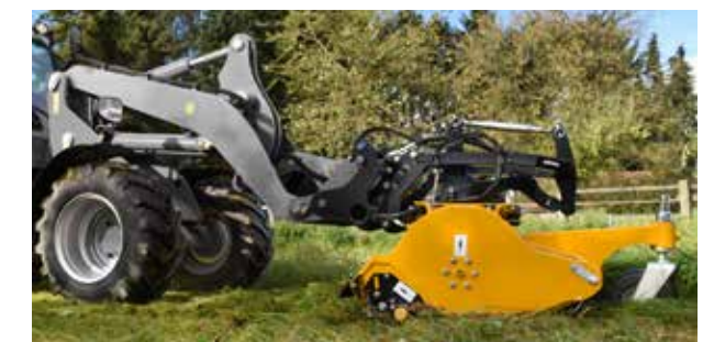
Un point de traction virtuel - Un brevet Mùthing : le broyeur est tracté avec une faible résistance au roulement au lieu d'être poussé, ce qui lui permet de suivre parfaitement le contour de sol en toute situation.
