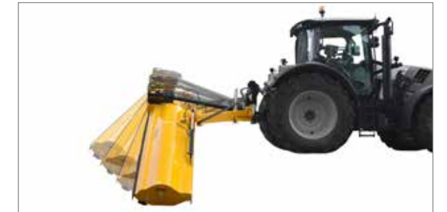
La sécurité d'effacement mécanique brevetée se déclenche de manière fiable et revient d'elle-même en position de travail.
