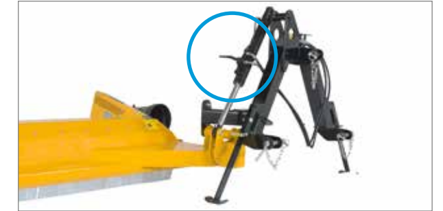
Sécurité de transport facilement verrouillable avec robinet d'arrêt.
