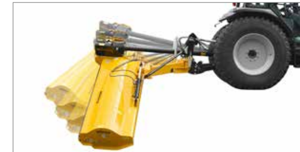
La sécurité d'effacement mécanique brevetée se déclenche de manière fiable et revient d'elle-même en position de travail.
