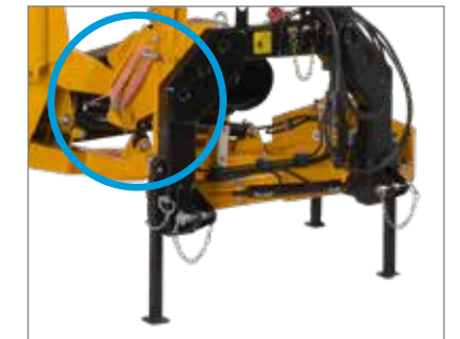
Sécurité de transport mécanique à verrouillage automatique pour être rapidement prêt pour le départ.
