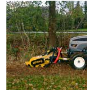
Le MU-C pour montage frontal : points attelage bas et un boîtier surbaissé (vitesse monorapport de 1.000 ou 2.000 tr/min).
