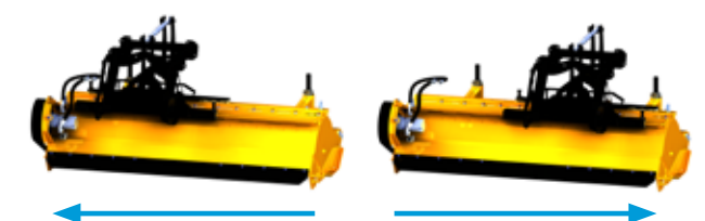
Déport latéral hydraulique avec course de déplacement de 26 cm. Broyage déporté à côté du véhicule pour plus de flexibilité autour des arbres, des entrées ou autres obstacles (en option). Le déport latéral mécanique est de série.
