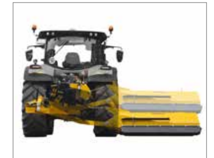
La hauteur du broyeur est réglable hydrauliquement. Ainsi, il est même possible de broyer sur des plateaux à côté du tracteur.
