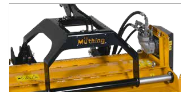
Le moteur à pistons axiaux puissant offre des réserves de puissance suffisantes même avec transmission hydraulique.
