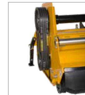
Vitesse de rotation de l'arbre de prise de force de 540 ou 1.000 tr/min possible.
