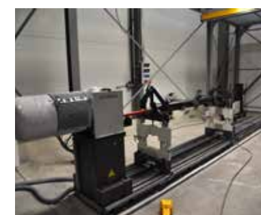
Notre propre banc d'équilibrage
