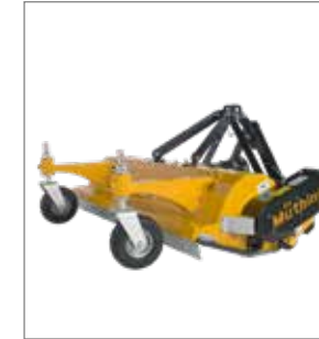
Le MU-C pour montage frontal : points attelage bas et un boîtier surbaissé (vitesse monorapport de 1.000 ou 2.000 tr/min).
