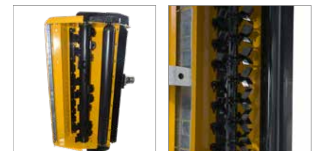
Couteaux cuillère montés sur manille « M » en carbure robustes à visser et le rouleau d'appui suiveur continu contribuent à l'obtention d'un résultat de tonte parfait. Couteaux en Y équilibrés disponibles en option.
