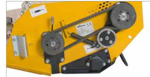
Travail sans encombre et peu d'entretien grâce au tendeur automatique de la courroie.
