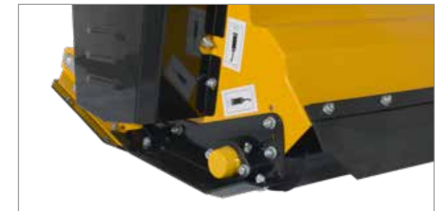
Rouleau palpeur réglable finement gradué pour le guidage en profondeur.
