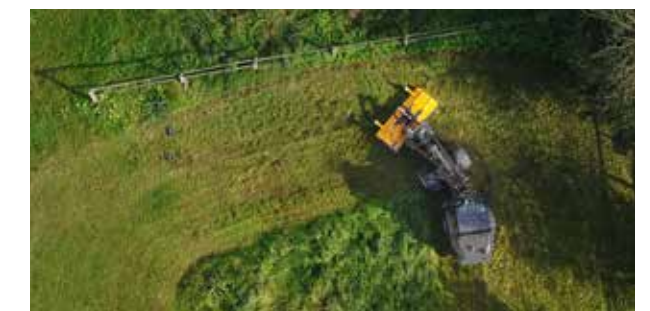
Marche à vide ingénieuse dans les virages, car la machine suit le rayon de braquage.
