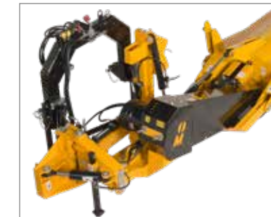
Prise de force directe grâce à une transmission compacte pour 1.000 tr/min.
