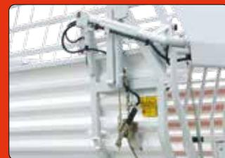
Également disponible sur demande avec **ouverture hydraulique de portière** vous permettant d'ouvrir confortablement la portière de l'autochargeuse à partir du siège du conducteur.
