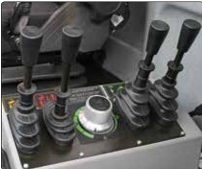
L'actionnement de l'**hydraulique** au moyen d'appareils de commande mécaniques est très apprécié sur le Muli T7 S. Il est disposé à portée de main, sur le côté du siège, garantissant un fonctionnement ergonomique.
