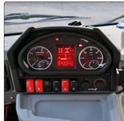
Intégrée de façon centralisée dans le tableau de bord, l'**unité d'affichage** offre au conducteur une vue parfaitement dégagée vers l'avant et un travail en tout confort. Cet instrument combiné fournit à l'opérateur toutes les informations importantes telles que la vitesse, les heures de service, le mode de direction, les niveaux, etc.
