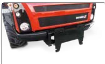
Grâce à la **plaque de montage pour outils**, les outils tels qu'une lame ou fraise à neige peuvent également directement être montés à l'avant.
