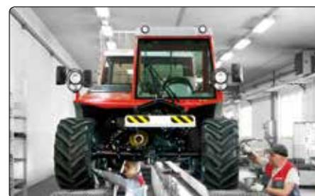
Lors du **contrôle final** et de la **finition**, tous les appareils sont contrôlés une dernière fois, puis conditionnés avant d'être expédiés.
