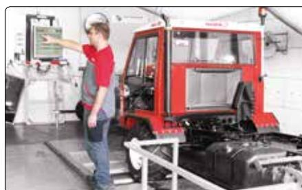
Avant la sortie d'usine, tous les véhicules sont soumis à des **essais de fonctionnement** intensifs comme, par ex., le contrôle sur banc d'essai de puissance à rouleaux (voir photo).
