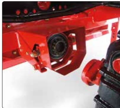
Le montage et le démontage de l'autochargeuse s'effectuent rapidement et **sans outils ni arbre** à cardans grâce au **système d'accouplement rapide** éprouvé de REFORM. Pour l'utilisateur, les forces d'actionnement restent très faibles.
