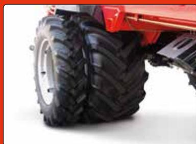
**Nous proposons un grand choix de pneumatiques** pour l'avant et/ou l'arrière. Les pneumatiques supplémentaires se montent et se démontent rapidement et sans problème grâce à l'attache rapide.
