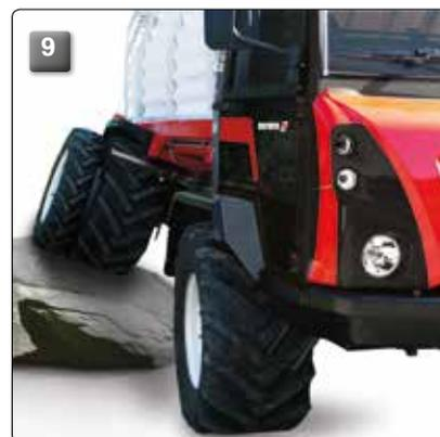
Entre l'essieu avant et l'essieu arrière, le **tronc central articulé (9)** est garant d'une parfaite adhérence des 4 roues sur le terrain et d'un déplacement de grande sécurité dans toutes les situations. Vous bénéficiez d'une pleine transmission de la force autant qu'un ménagement optimal du sol, même sur les terrains difficilement praticables.
