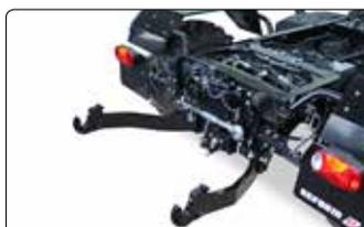
Le **relevage AR 3 points** existe en différents modèles avec bras de levage rigides ou mobiles.
