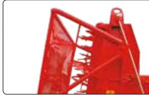
**Paroi de protection arrière à actionnement hydraulique**
