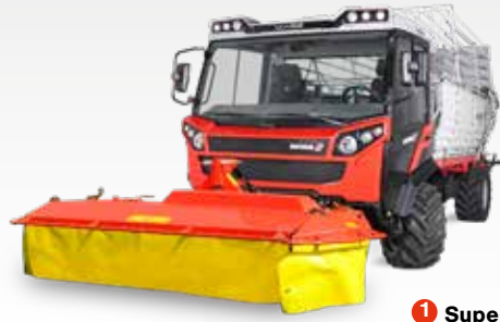
1 Superstructure de l'autochargeuse 2 Faucheuse à disques
