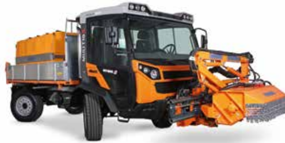
1 Tribenne avec système de réservoir 2 Épareuse
