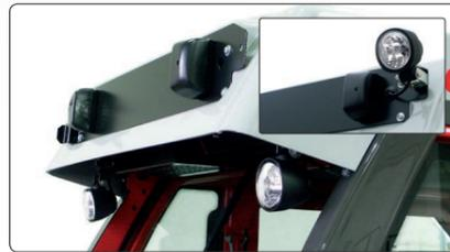
Un ou deux **phares de travail** montés sur le toit de la cabine ou au-dessous permettent une vision optimale de la zone de travail arrière.
