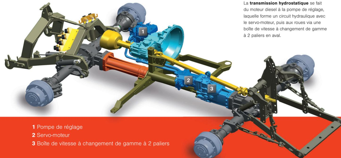
La **transmission hydrostatique** se fait du moteur diesel à la pompe de réglage, laquelle forme un circuit hydraulique avec le servo-moteur, puis aux roues via une boîte de vitesse à changement de gamme à 2 paliers en aval.
