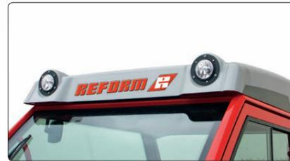
Les **feux auxiliaires** (également à LED sur demande) avant intégrés dans le toit assurent une visibilité maximale et transforment la nuit en jour.
