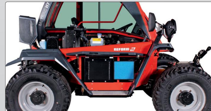
Le H7 RX mise sur la **facilité d'entretien** et sur l'accessibilité optimale des composants. Toutes les trappes d'entretien et de maintenance s'ouvrent ainsi sans outils et en toute simplicité. Les travaux d'entretien quotidiens sont en particulier facilités : contrôle et entretien du liquide de lave-glace, filtre à air, niveau d'huile, réservoir du liquide de freinage, liquide d'embrayage, etc.
