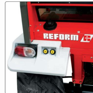
Facile d'accès, la **tubulure de remplissage** permet de faire rapidement le plein et la **commande électrique de l'extérieur** du relevage facilite le montage et le démontage des outils de travail.
