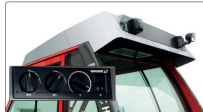
Une atmosphère de travail optimale grâce à la **climatisation** intégrée en toiture (de série sur H7 X / H9 X) ou à un apport d'air frais supplémentaire dans la cabine fermée par la **ventilation intégrée dans le toit** (sauf G7 RX / H7 RX / H7 X / H9 X).
