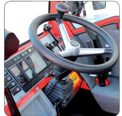
La **colonne de direction réglable en inclinaison** garantit une position assise optimale.
