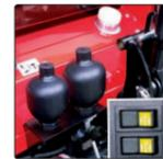
Les boules d'azote absorbent une grande partie des vibrations générées lors de déplacements avec de lourds outils portés, en particulier sur route.
