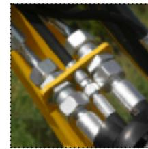
Ligne hydraulique rotor
