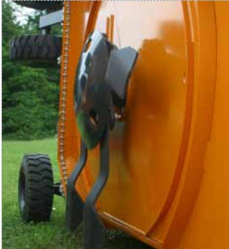
↖ **Essieux balancier sur plateau central** pour BGL 460 et 620 (sur plateau central et ailes pour BGL 820)
