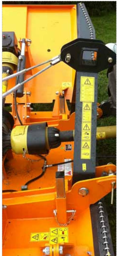
→ Attelage flottant sur le bras de relevage permettant un meilleur suivi du terrain
