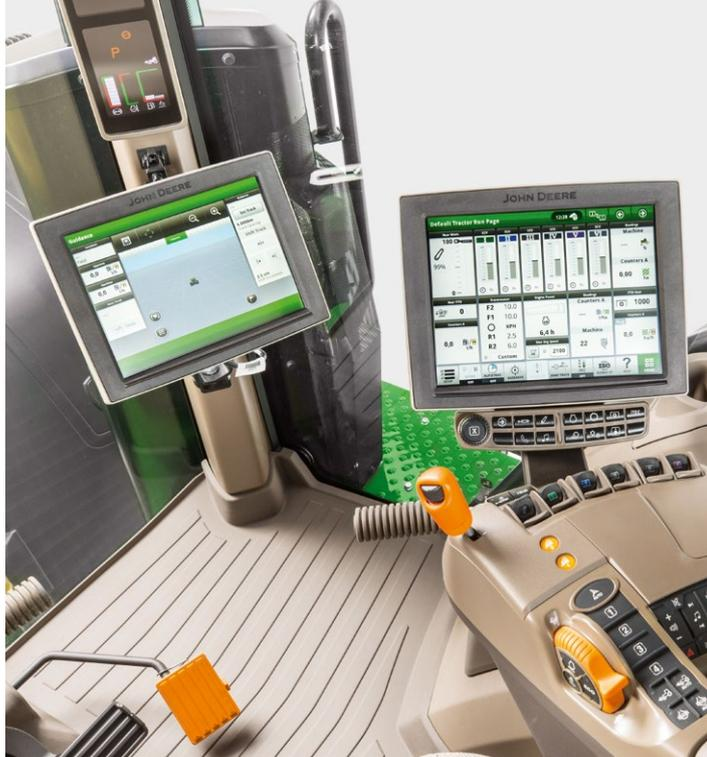
La navigation se fait facilement, à l'aide de menus logiques et d'une barre de raccourcis complète. La fonction Quick Line vous permet d'enregistrer une ligne AB d'une simple pression sur un bouton.
