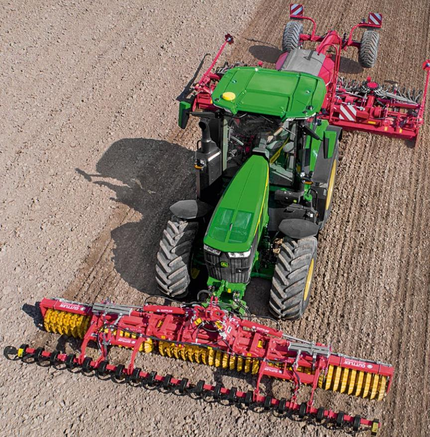
AutoTrac est désormais disponible pour des vitesses minimales de 100 m/h et fournit une précision deux fois plus élevée pour les applications à haute vitesse jusqu'à 16 km/h.
