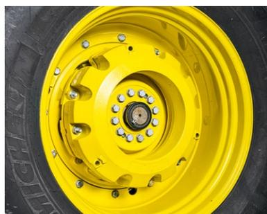
70 kg de poids de démarrage + 1x/2x 205 kg de masse flexible pour toutes les tailles de pneus
