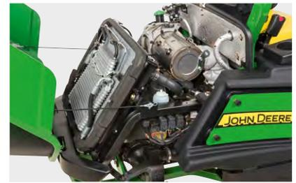
**Entretien aisé :** Jamais l'entretien d'une tondeuse n'a été aussi simple ! Tous les points d'entretien quotidien sont facilement repérables et accessibles, et le carter de coupe pivote pour faciliter le nettoyage et le remplacement des lames.
