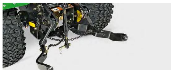
**Relevage 3 points arrière :** Cet relevage 3 points proposé en option permet d'accrocher et de lever facilement de lourds équipements arrière. La prise de force arrière, en option, transmet le couple moteur aux herbes, pulvérisateurs ou épandeurs arrière.
