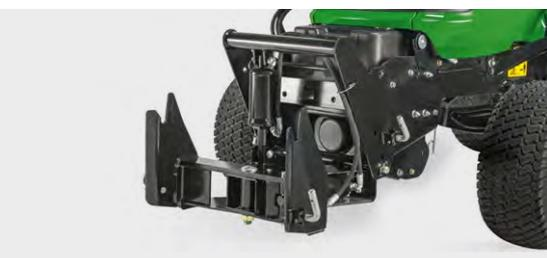
**Attelage avant :** Le système d'accrochage « Quick-Tatch » facilite l'attelage et la commande des outils frontaux, tels que la lame frontale et la balayeuse. Son système hydraulique soulève et fait pivoter les équipements.
