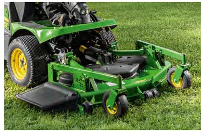
**Pneus de carter :** Rien ne peut les arrêter car, même perforés, ces pneus semi-pneumatiques pour roues pivotantes ne mollissent pas.
