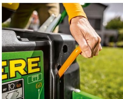
**Frein de stationnement :** Le frein de stationnement est situé à portée de main et maintient la tondeuse en position de stationnement de manière très sûre, même sur un terrain en pente.
