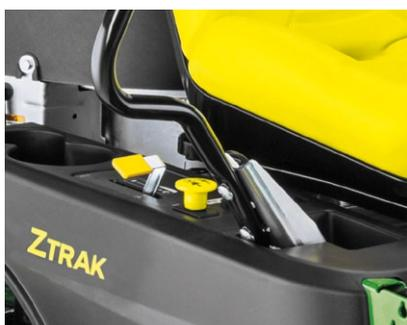
**Prenez le contrôle :** Le panneau de commande de l'utilisateur est bien accessible et facile à utiliser. Il comporte un compteur d'heures de service, un voyant d'avertissement de faible niveau de carburant, le contacteur de démarrage, la commande de prise de force et la commande de régime moteur/starter.
