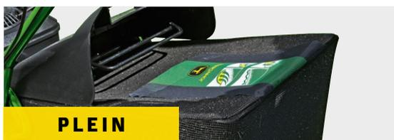
**Témoin de remplissage du bac de ramassage\*** : Pas de débordement : un indicateur pratique vous signale lorsqu'il est temps de vider le bac de ramassage.
