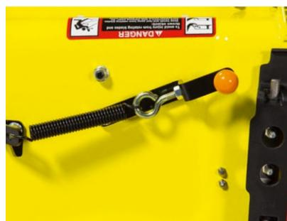
Le bac de ramassage Power Flow peut également être utilisé avec l'accessoire MulchControl et les lames de mulching. Il suffit, dans ce cas, de placer le levier en position d'éjection latérale.
