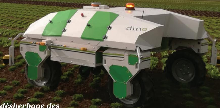
***“Le robot permet d’automatiser le désherbage des cultures, et sa grande idée est d’être autonome. Le désherbage mécanique permet ainsi de supprimer le désherbage chimique, bénéfique à la fois pour les cultures et pour l’environnement ”***
