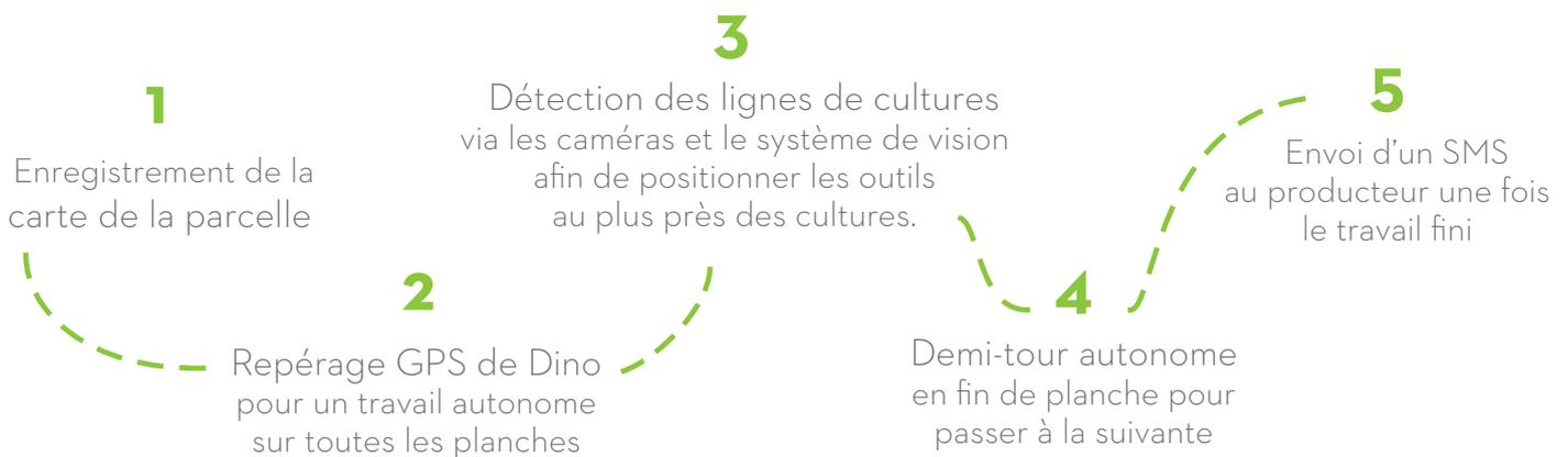
Le guidage GPS couplé à la vision caméra permet à Dino d'être opérationnel dans un maximum de cas tout en étant précis.
