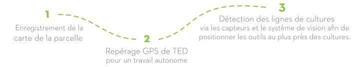
Le guidage GPS couplé à des capteurs permet à TED d'être opérationnel dans un maximum de cas tout en étant précis.
