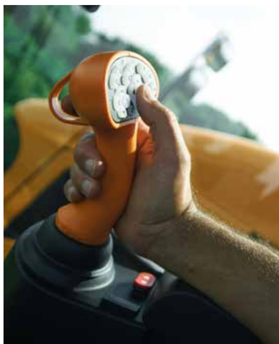
Contrôle des outils depuis le Joystick Easy Drive
