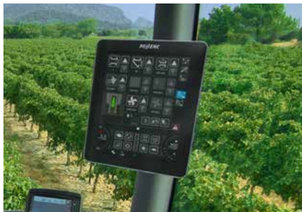
Contrôle simultané de deux outils depuis le pupitre de commande
