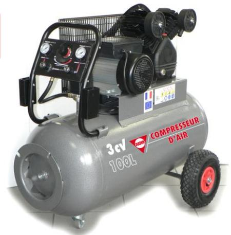
**Caractéristiques techniques :**Capacité de la cuve en litres : **100**Nombre cylindres : **2**Pression maxi en bar : **9**Nombre de tours mn : **1140**Débit d'air aspiré : **347 l/mn - 21 m3/h**Type : **lubrifié**Débit d'air restitué à 7 bar : **270 l/mn - 16 m3/h**Puissance en cv : **3****Les "plus" produit :**
