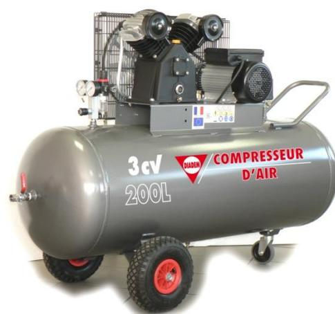
**Caractéristiques techniques :**Capacité de la cuve en litres : **200**Pression maxi en bar : **9**Débit d'air aspiré : **380 l/mn - 22.8 m3/h**Débit d'air restitué à 7 bar : **310 l/mn - 18.6 m3/h**Nombre cylindres : **2**Nombre de tours mn : **1243**Type : **lubrifié**Puissance en cv : **3****Les "plus" produit :**
