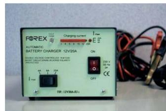
Les chargeurs FOREX sont étudiés pour une recharge optimum des batteries destinées à l'alimentation principale ou au démarrage des engins TP/ Agricoles, des campings cars, auto, PL, Bus, Bateaux... Les chargeurs FOREX utilisent la technologie du découpage à haute fréquence. Leur système de contrôle électronique de charge permet un ajustement permanent du courant de charge en fonction des besoins de la batterie.
