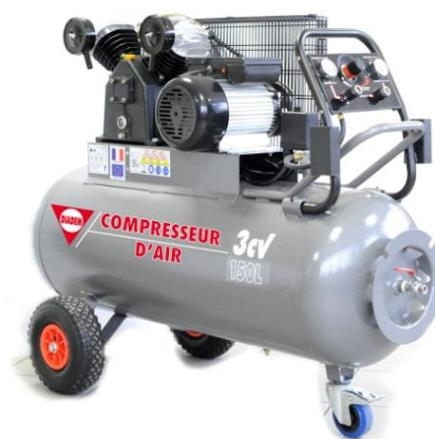
**Caractéristiques techniques :**Capacité de la cuve en litres : **150**Nombre cylindres : **2**Pression maxi en bar : **9**Nombre de tours mn : **1243**Débit d'air aspiré : **380 l/mn - 23 m3/h**Type : **lubrifié**Débit d'air restitué à 7 bar : **310 l/mn - 18 m3/h**Puissance en cv : **3****Les "plus" produit :**
