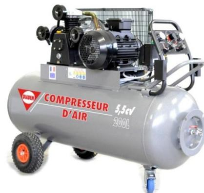
**Caractéristiques techniques :**Capacité de la cuve en litres : **200**Nombre cylindres : **3**Pression maxi en bar : **9**Nombre de tours mn : **1243**Débit d'air aspiré : **585 l/mn - 35 m3/h**Type : **lubrifié**Débit d'air restitué à 7 bar : **450 l/mn - 26 m3/h**Puissance en cv : **5.5****Les "plus" produit :**
