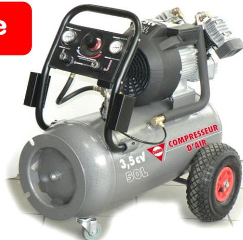
**Caractéristiques techniques :**Capacité de la cuve en litres : **50**Nombre cylindres : **2**Pression maxi en bar : **8**Nombre de tours mn : **2960**Débit d'air aspiré : **370 l/mn - 23 m3/h**Type : **lubrifié**Débit d'air restitué à 7 bar : **290 l/mn - 17 m3/h**Puissance en cv : **3,5****Les "plus" produit :**
