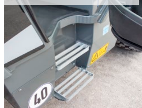
Accès cabine en escalier
