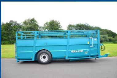
▲ Surbaisseur hydraulique avec boule d'azote: descente rapide et montée des animaux optimale
