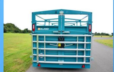
▲ Feux full LEDS de type transport routier avec option 3<sup>ème</sup> feu stop
