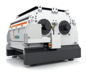
Les broyeurs M&J FineShred 4500 et 6500 à deux arbres sont adaptés à la production de CSR et peuvent fournir un débit de 20 t/h en fonction de la granulométrie définie en sortie.
