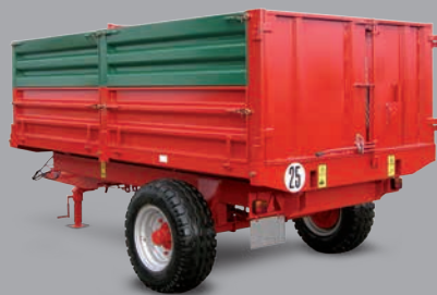
■ Porte arrière type betteravière (hauteur 1 m) ► En tôle de 3 mm ► À 2 charnières pour une ouverture aisée
