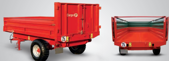
■ Porte arrière type betteravière (hauteur 1 m) ► En tôle de 3 mm ► À 2 charnières pour une ouverture aisée
