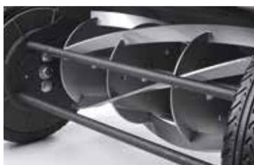
L'avancement des roues actionne le cylindre composé de 5 lames inoxydables qui taillent l'herbe comme des ciseaux.
