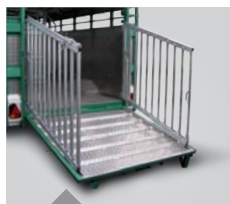
Barrières accordéon sur pont hydraulique (photo avec option tôle ALU)
