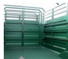
Barrières intérieures 2 battants fixés à un cadre anti-retour sur galet
