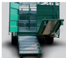
Pont rabattable 2 battants assisté par ressort (photo avec option tôle ALU)
