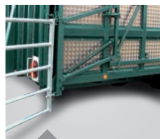
Barrières latérales sur rail coulissantes, pivotantes et option pose au sol
