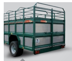
Porte arrière à ouverture intégrale 2.10 m pour gamme HVX
