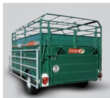
Pont rabattable 2 battants assisté par ressort (photo avec option tôle ALU)
