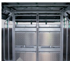
Barrières intérieures 2 battants sur rail avec verrouillage automatique (photo avec option galvanisée)
