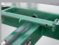
Moulinet : - 1 de 600 mm à l'avant - 2 de 300 mm à l'arrière
