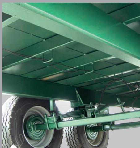
Longerons tubulaires HLE 200 x 100 ép. 8 mm (sauf SP 6006 : ép. 5 mm) Traverses sous plancher en tube de 100 x 50 x 3.2 mm (sauf SP 6006 : 80 x 40 x 3 mm)
