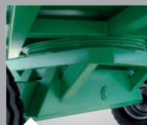
Tourelle AV oscillante fabriquée en tôle de 6 et 8 mm
