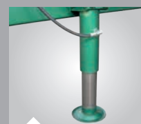
Béquille hydraulique par distributeur tracteur en std
