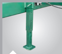
Béquille à collier en standard (hydraulique en option)
