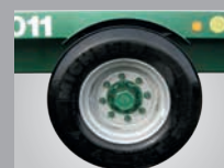
Roues encastrées pour une faible hauteur de plancher Pneumatiques routiers en std
