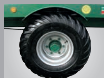
Roues encastrées pour une faible hauteur de plancher
