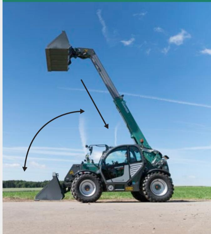
Lors de l'abaissement du bras chargeur, le bras télescopique se rétracte automatiquement. Ainsi, le chargement se fait toujours le plus près possible du véhicule, ce qui permet d'éviter les situations critiques même avec des charges utiles maximales. Le mode godet est idéal pour charger des matériaux en vrac.
