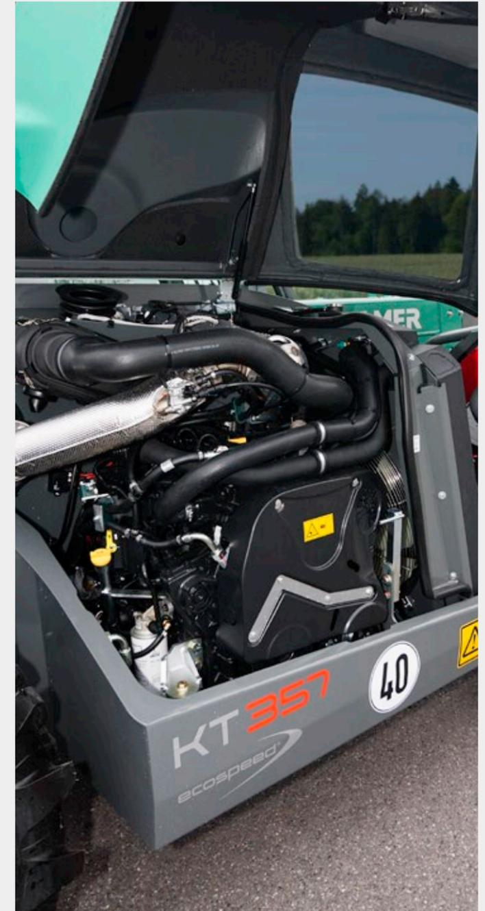
**Moteur 4 cylindres en ligne à refroidissement liquide**
