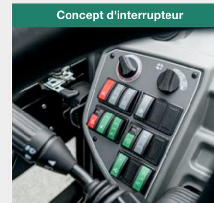
Toutes les touches et interrupteurs de la machine ont un code couleur pour que l'opérateur puisse trouver rapidement la fonction souhaitée. Les touches pour les fonctions de sécurité sont rouges, celle pour l'hydraulique sont vertes, grises pour électrique et bleues pour la transmission. Afin de pouvoir toujours trouver le bon interrupteur même dans la pénombre, tous les éléments de contrôle sont rétroéclairés.
