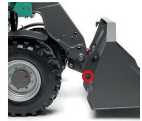
**Changer d'équipement hydraulique (en option) : le système d'attache rapide Kramer :** approcher simplement la machine de l'équipement, fixer l'équipement depuis la cabine, puis verrouiller l'équipement hydrauliquement en appuyant sur le bouton de défilement situé sur le joystick. Le vérin de verrouillage est situé à l'extérieur du point de pivotement de la plaque d'attache rapide et ne se trouve donc pas dans la zone de salissure.
