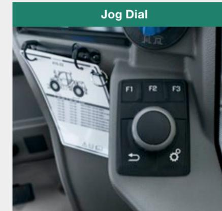
La cabine est équipée de ce que l'on appelle un Jog Dial. Celui-ci permet d'ajuster en tout confort tous les paramètres importants de la machine, par exemple la quantité d'huile de tous les circuits hydrauliques. Il permet aussi d'afficher et d'adapter les différentes données de fonctionnement grâce à la molette de sélection en fonction des besoins de chaque conducteur.
