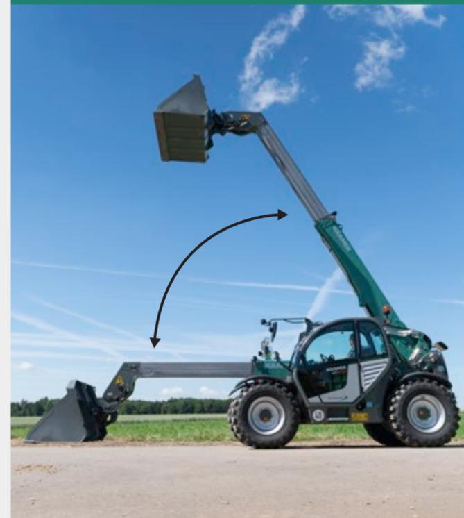
En mode manuel, le bras chargeur n'effectue aucun mouvement automatique. Le limiteur de surcharge reste naturellement actif et arrête le bras chargeur dès que la limite de surcharge est atteinte. À ce moment, il est uniquement possible de rétracter et soulever le bras chargeur et de basculer l'équipement.
