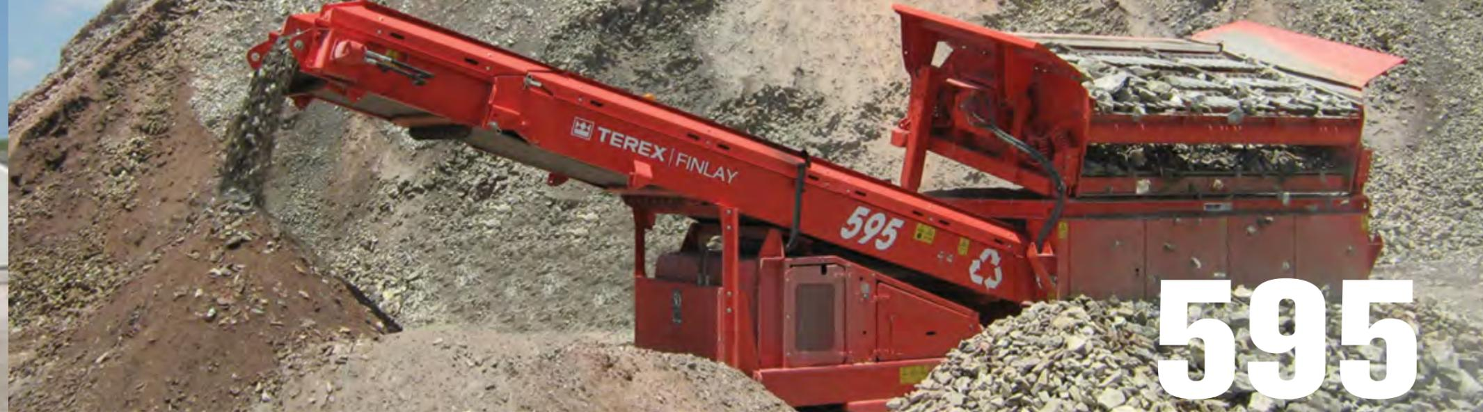
Le Terex® Finlay 595 Hydratrak est une unité de scalpage mobile, autonome et haute capacité. Conçu et fabriqué sur la base de critères très stricts, le 595 est capable de supporter les applications les plus exigeantes englobant notamment la récupération des déchets, l'exploitation en carrière et la démolition. Il est équipé d'un scalpeur vibrant renforcé à double étage, d'un châssis avec chenilles et d'une télécommande.
