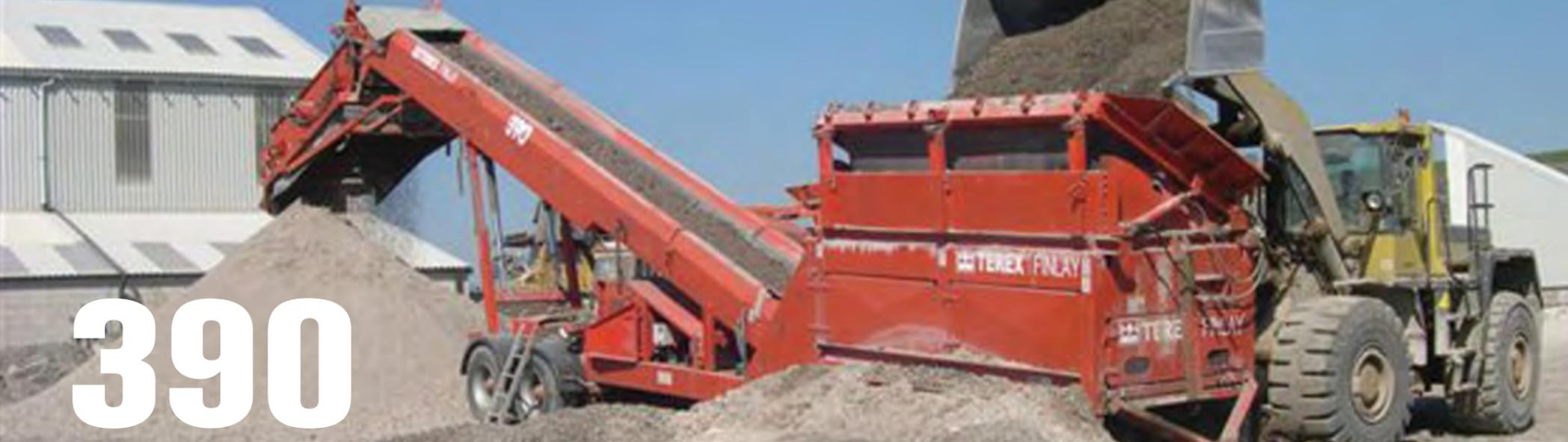
La Terex® Finlay 390 a été conçue pour la production d'agrégats en grande quantité. L'angle de crible réglable hydrauliquement ainsi que la trémie de forte capacité lui autorise une grande polyvalence que ce soit en lavage de sable et gravier ou criblage de charbon. L'équipement optionnel peut comprendre un scalpeur vibrant simple ou double étage, cribles 3 étages, émotteur, passerelles de crible et dispositif de lavage.
