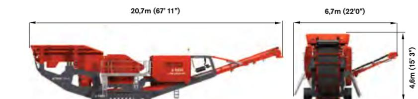
Poids de la machine: 75,200kg (165,787lbs) Hinweis – Standard-Maschinenkonfiguration
