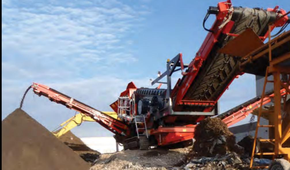
Le nouveau Terex Finlay 883 Spaleck est l'équipement ultime en matière de technologie de criblage et de séparation. Cette machine intègre un crible à deux étages de conception allemande pour le recyclage hautes performances, équipé de la technologie Flip-Flow-Screen Elastica. La conception inédite de l'étage supérieur, associée à la technologie de pointe Flip-Flow sur le niveau inférieur, fait du 883 Spaleck un équipement unique en son genre.
