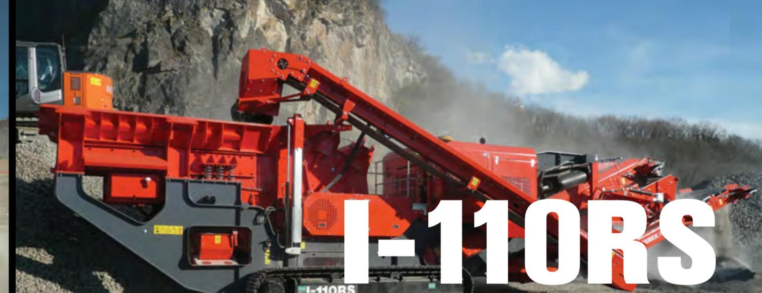
Le Terex® Finlay I-110RS combine le concassage et le criblage en un seul châssis. Basée sur le Terex® Finlay I-110, cette machine propose un système innovant de crible deux étages 3660 mm x 1500 mm (12' x 5") détachable rapidement, pour le criblage et la recirculation des refus vers la chambre de concassage. Le crible peut être retiré rapidement lorsque l'application ne nécessite pas de reclassement ou de recirculation des matériaux.
