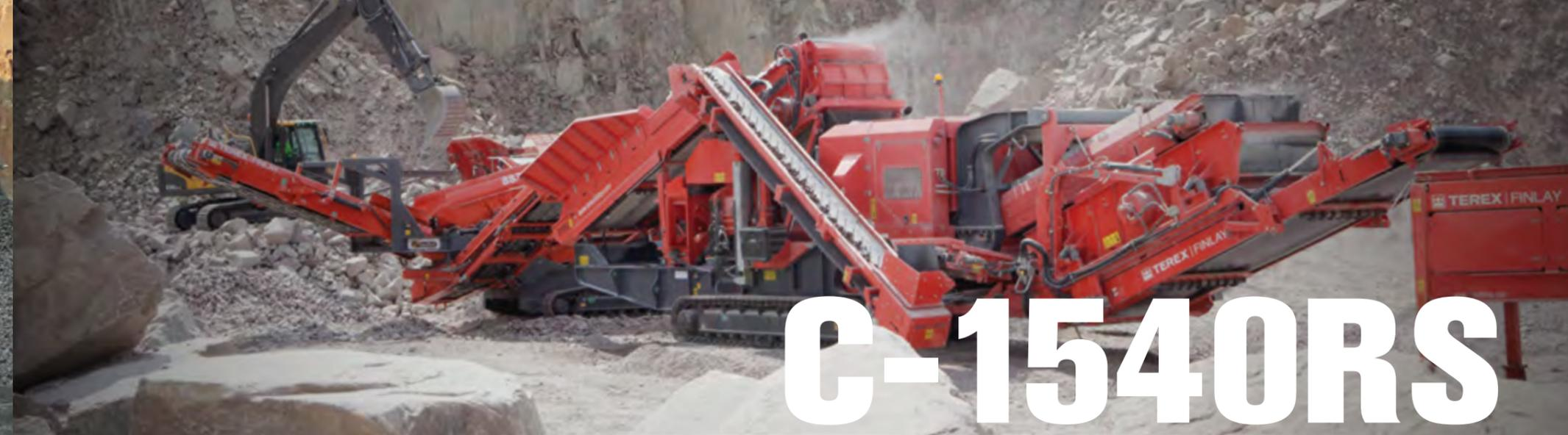
Le concasseur giratoire mobile sur chenilles Terex Finlay C1540 bénéficie d'une réputation établie dans les applications d'agrégats et d'exploitation de minerai à ciel ouvert. Cette machine efficace et productive incorpore le concasseur giratoire Terex 1000 avec un entraînement hydrostatique variable direct, un relâchement automatique du bol et un réglage hydraulique du serrage.
