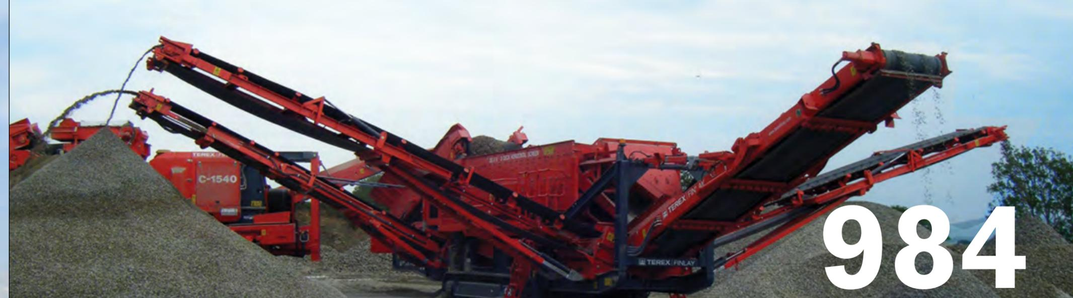
Le crible Terex Finlay 984 est un crible horizontal 3 étages hautes performance facile à installer, polyvalent et idéal pour le traitement de gros volumes de matériaux dans les applications carrières, recyclage et mines...
