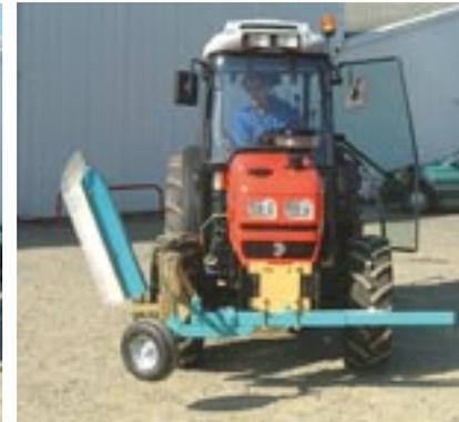
rampe 1/2 rang déploiement horizontal de 800 mm 07.00.95
