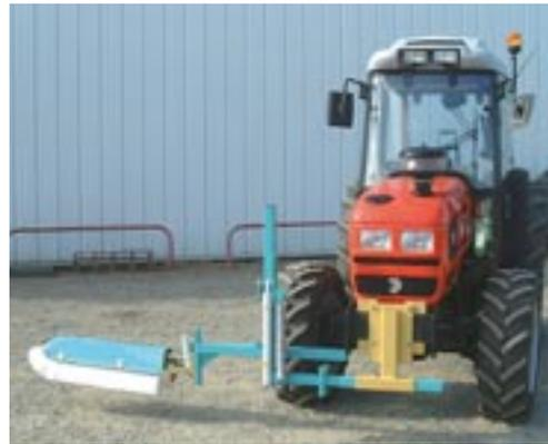
rampe verger hydraulique vertical 350mm et inclinaison du capot 07.00.52
