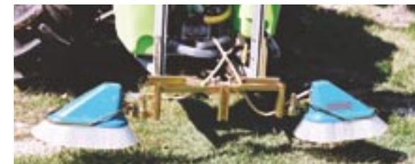
**rampe vigne « spécial enherbement »** escamotable buses anti-dérive à jet déporté 90° - largeur traitée 0,40 m
