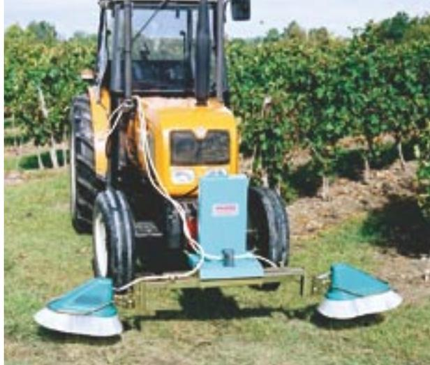
**rampe vigne avant**, relevage vertical, course 350mm - réglage de la largeur par moteur hydraulique de 1,80 m à 3,20 m
