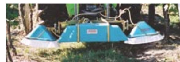
**rampe avec tunnel central** pour plantations de 1,80 m à 2,80 m
