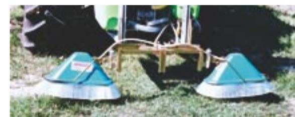
**rampe vigne avec capots** équipés de buses pinceau anti-dérive 120° - largeur traitée 0,60 m
