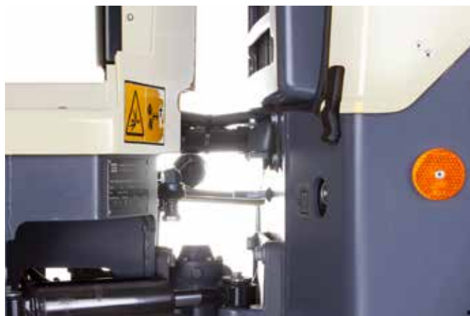
Direction articulée avec pivot de direction et cylindre d'articulation centrale sans entretien pour réduire la maintenance.
