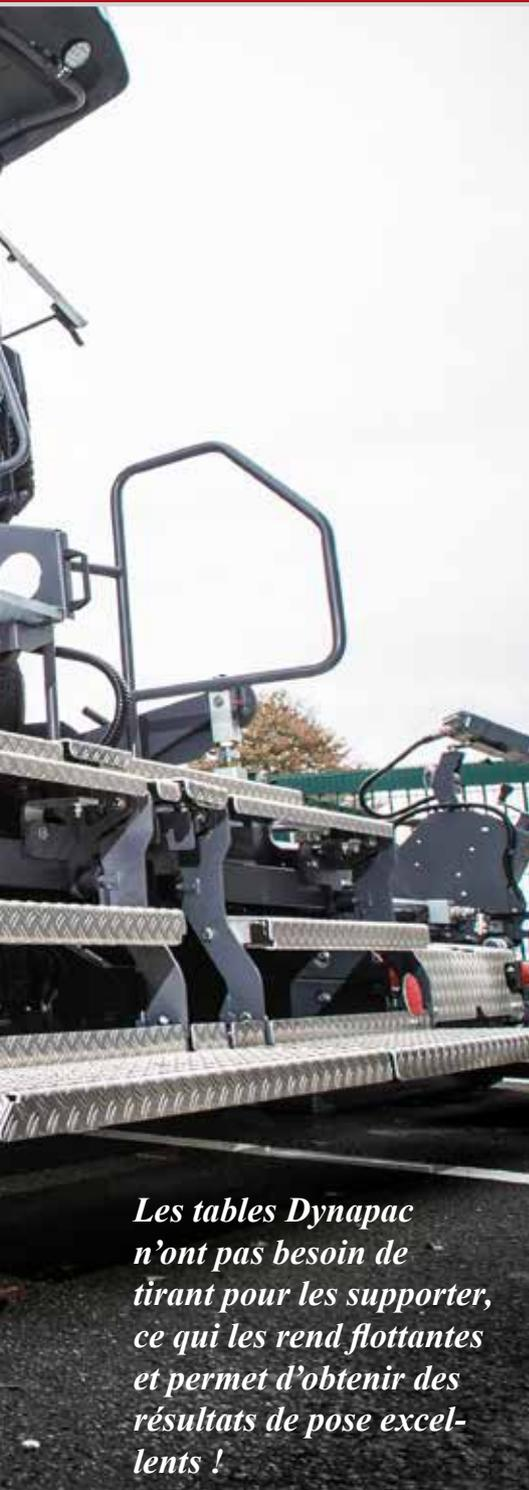
*Les tables Dynapac n'ont pas besoin de tirant pour les supporter, ce qui les rend flottantes et permet d'obtenir des résultats de pose excellents !*
