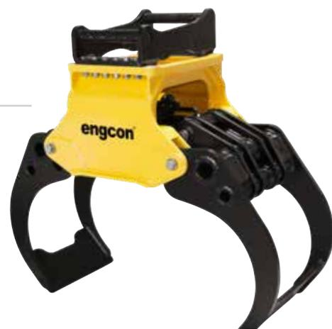
Les grappins à grumes TGHD (Timber Grab Heavy Duty) engcon sont, associées à un tiltrotateur, l'outil idéal pour traiter des grumes et tubes, ou pour effectuer des travaux de tri légers. Les grappins sont renforcés d'acier anti-usure à haute résistance d'une dureté de 400 brinell et peuvent s'adapter à un grand nombre de platines.
