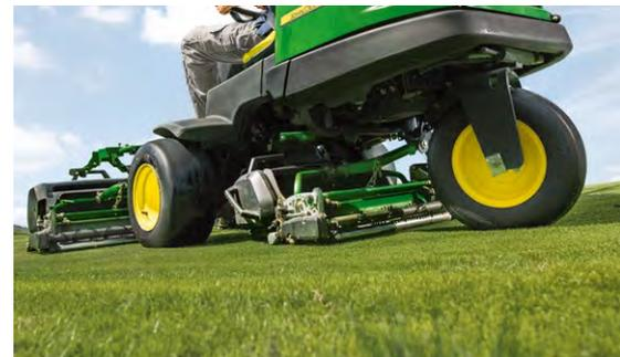
**Réduction du double roulage :** les roues ne dépassent pas des unités de coupe afin de réduire, voire d'éliminer, le double roulage en ligne droite (série 2550).
