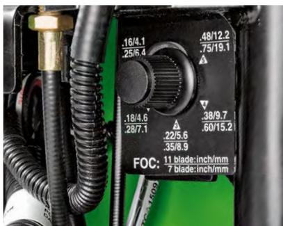
**Fréquence de coupe réglable avec dispositif de verrouillage :** la fréquence de coupe peut être réglée au moyen d'un simple bouton, puis verrouillée mécaniquement pour éviter tout changement ultérieur.
