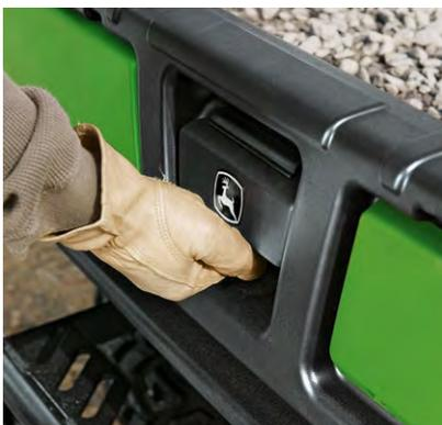
**Hayon :** le hayon de type pick-up s'ouvre d'une seule main vers l'extérieur à 90 degrés et vers le bas à 150 degrés.
