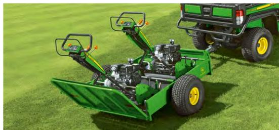
**Remorque 22B** : sa rampe à inclinaisons multiples facilite le transport des tondeuses à conducteur marchant jusqu'au green suivant.
