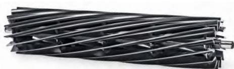
**Cylindre à 14 lames :** La fréquence de coupe est déterminée par la vitesse du cylindre, la vitesse de tonte et le nombre de lames sur le cylindre. Nous proposons un choix d'unités à 7, 11 et 14 lames répondant à tous les besoins.
