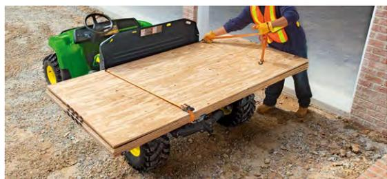
**Plate-forme :** Il est possible de déposer les panneaux latéraux de la benne en quelques minutes pour la convertir en plateau.
