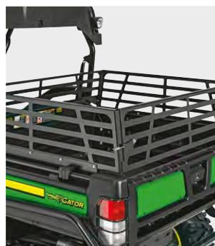
**Rehausses de benne :** augmentez la hauteur et le volume de la benne pour doubler sa capacité de transport. La partie supérieure pivotante du hayon facilite l'accès.
