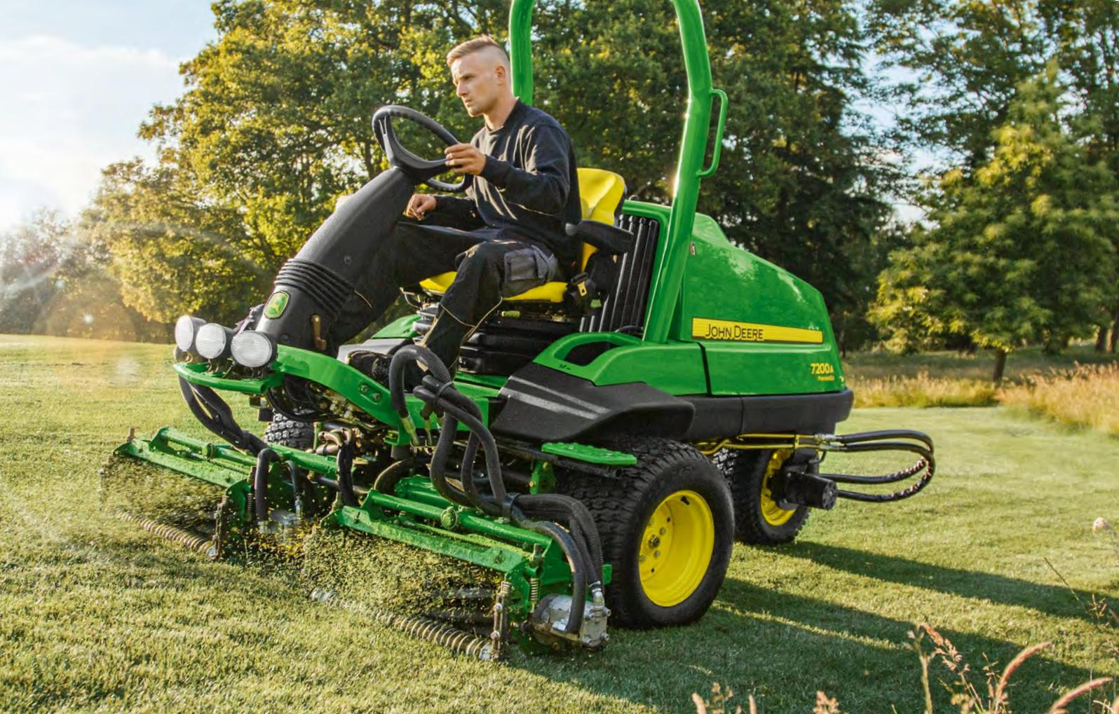
**Stabilité (2653B) :** un centre de gravité très bas allié à un empattement large de 140 cm (55") garantit un fonctionnement sûr et confortable, même dans les conditions de tonte les plus difficiles.
