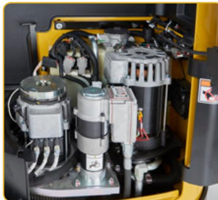
L'accès est aisé grâce au capot pivotant du compartiment moteur. Le moteur de direction utilise également la technologie du courant alternatif assurant une commande de direction précise. Au démarrage, la roue motrice se centre automatiquement. Une plaque amovible permet d'accéder au pneu de la roue motrice et au réducteur de vitesse pour l'entretien. Le compartiment moteur, moteur de levage compris, est ventilé.
