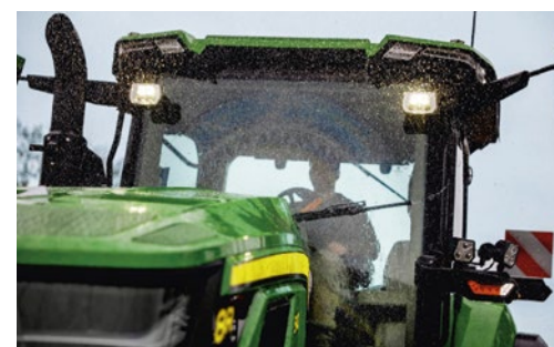
Couverture de l'essuie-glace du pare-brise avant à 330°
