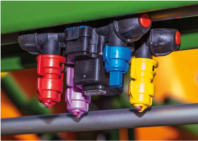
✓ Coupure électrique buse à buse AmaSelect
