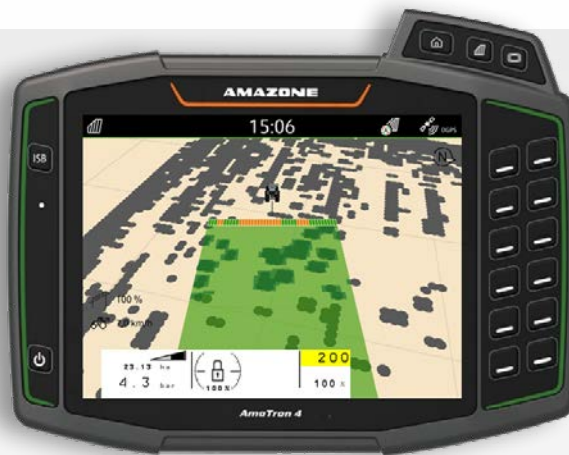
Intégration de la carte de zones ciblées dans le terminal ISOBUS AmaTron 4
