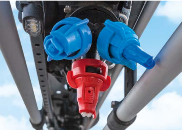
✓ Coupure électrique buse à buse AmaSwitch plus
