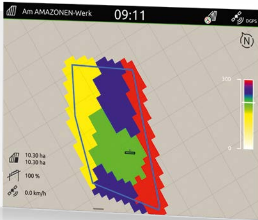
Représentation d'une carte de modulation sur l'AmaTron 4
