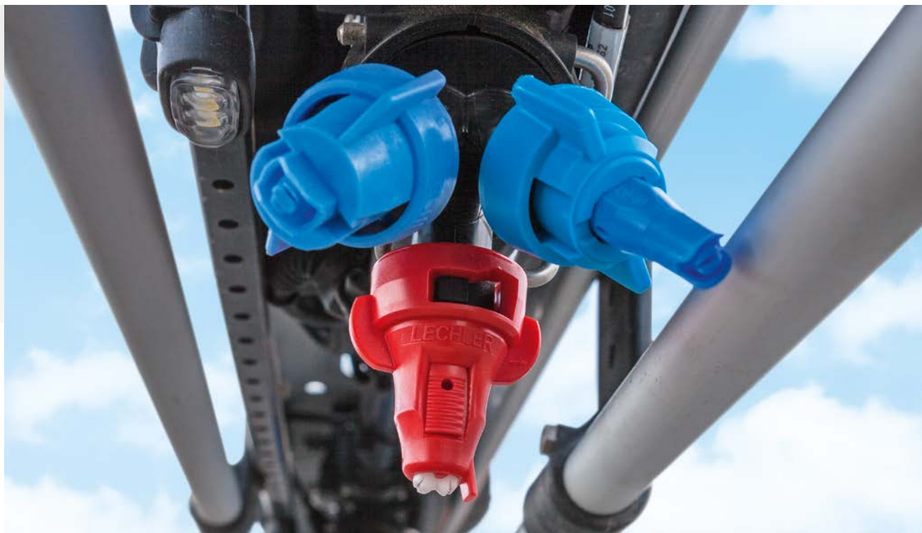
Trijets AmaSwitch plus avec éclairage individuel des buses par LED
