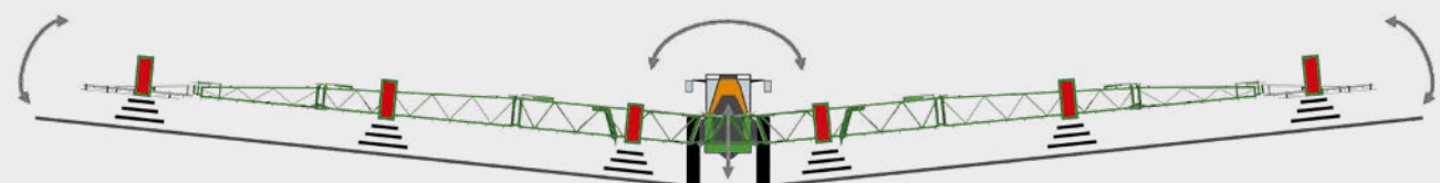
Géométrie variable des deux côtés (repliage Flex 2)
