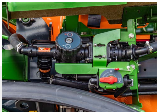
✓ HighFlow + est équipé d'un filtre pression supplémentaire autonettoyant
