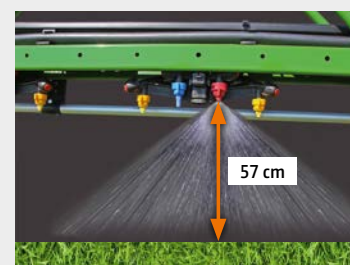
Buse 110° : Ecart entre buses 50 cm
